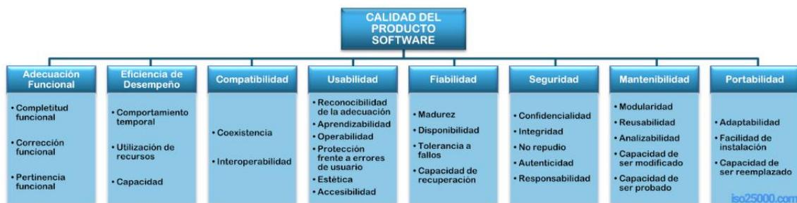
**Ilustración 2-12:** Esquema de la ISO 25010
