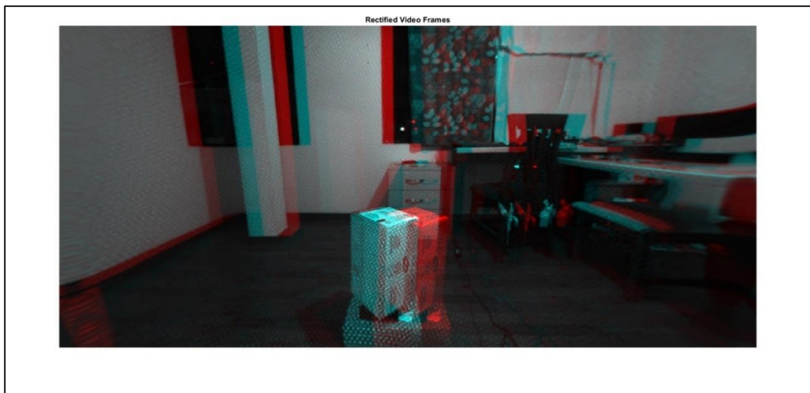
Ilustración 27-3: Rectificación de imágenes.
