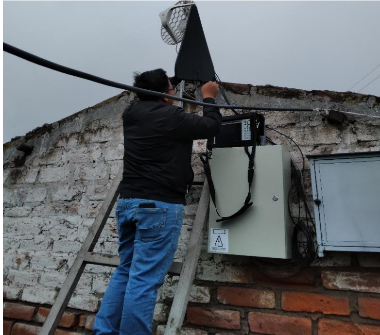
Ilustración 26-3: Barrido de frecuencia con el analizador de espectros Deviser E8600B en el nodo Guarguallá.
