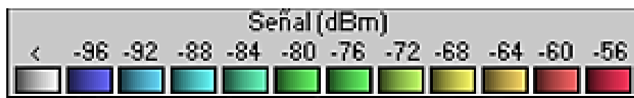
Ilustración 48-3: Indicador del nivel de potencia de recepción mediante código de colores.
