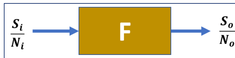
Ilustración 10-2: Diagrama del umbral de la señal a ruido en el receptor.
