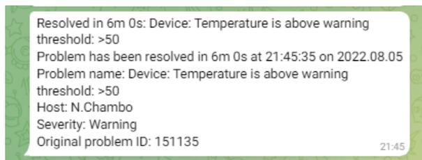
**Ilustración 41-3:** Comunicación exitosa entre Zabbix y Telegram para control en el sistema
