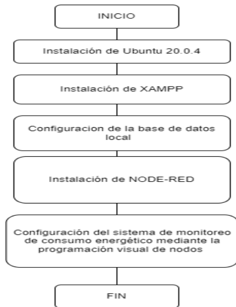
Ilustración 18-3: Diagrama de procesos a ejecutar en el servidor local
