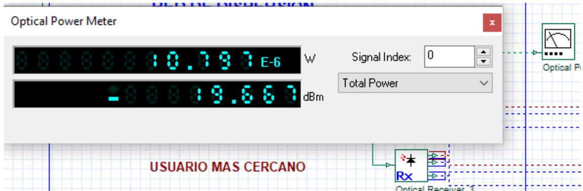
**Ilustración 11-4:** Potencia de salida del usuario más cercano
