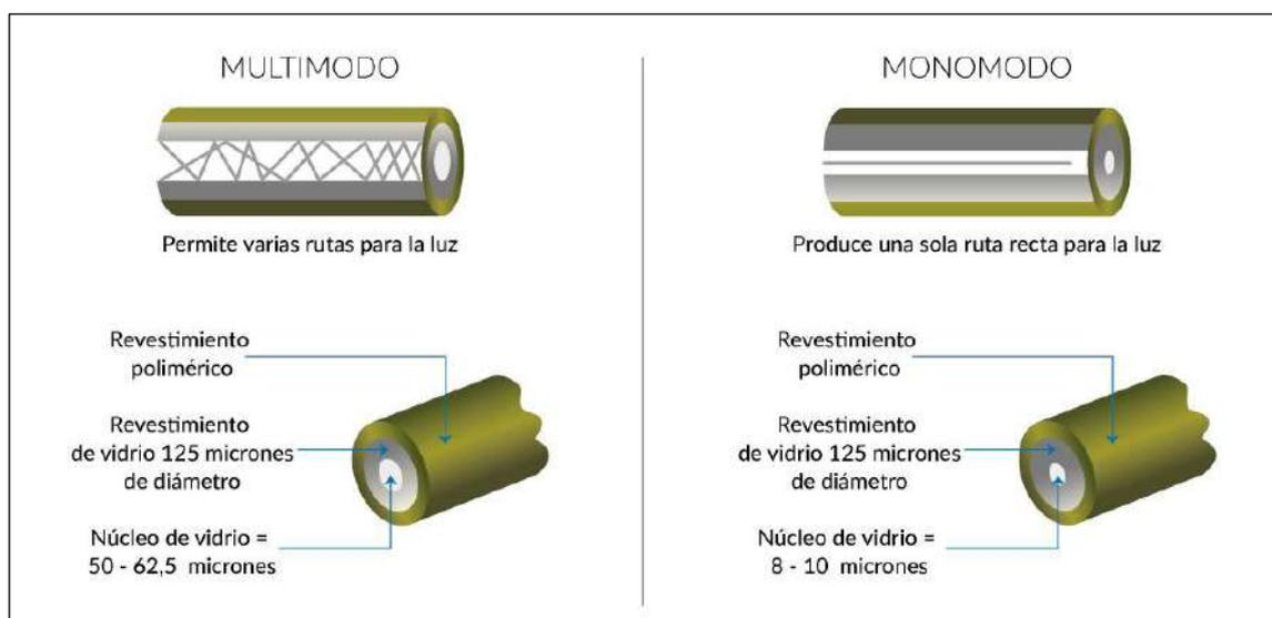
**Ilustración 5-2:** Tipos de fibra óptica
