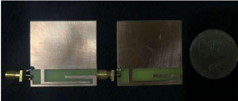
**Ilustración 5 – 4.** Soldadura de conector SMA en la antena
