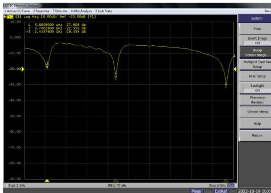
**Ilustración 6 – 4.** Prueba de la antena multibanda, coeficiente de reflexión frecuencia 2.4 GHz, 3.8 GHz y 5.4 GHz
