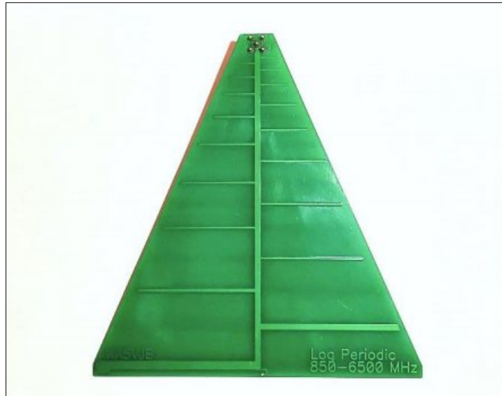
Ilustración 8-2: Antena Log Periodic 850 a 6500 MHz
