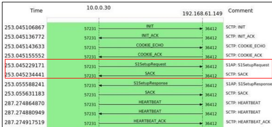
Ilustración 40-4: Flujo de mensajes de la interfaz S1-MME – Protocolos SCTP/S1AP
