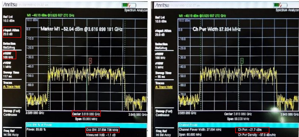
Ilustración 16-4: Espectro de la señal NR (n78 - 3.619 GHz)
