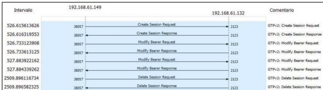
Ilustración 38-4: Flujo de mensajes entre MME y SPGWC – Protocolo GTPv2
