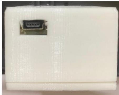
**Ilustración 11-3:** Puerto USB del prototipo
