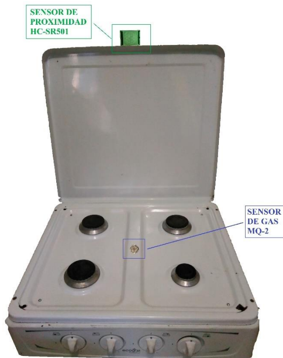
Figura 12-3: Sensores de la parte superior de la cocina
