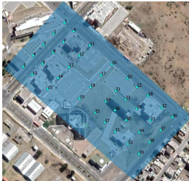
**Ilustración 38-3:** Mapeo electromagnético referente a la desviación estándar negativa linealizada.
