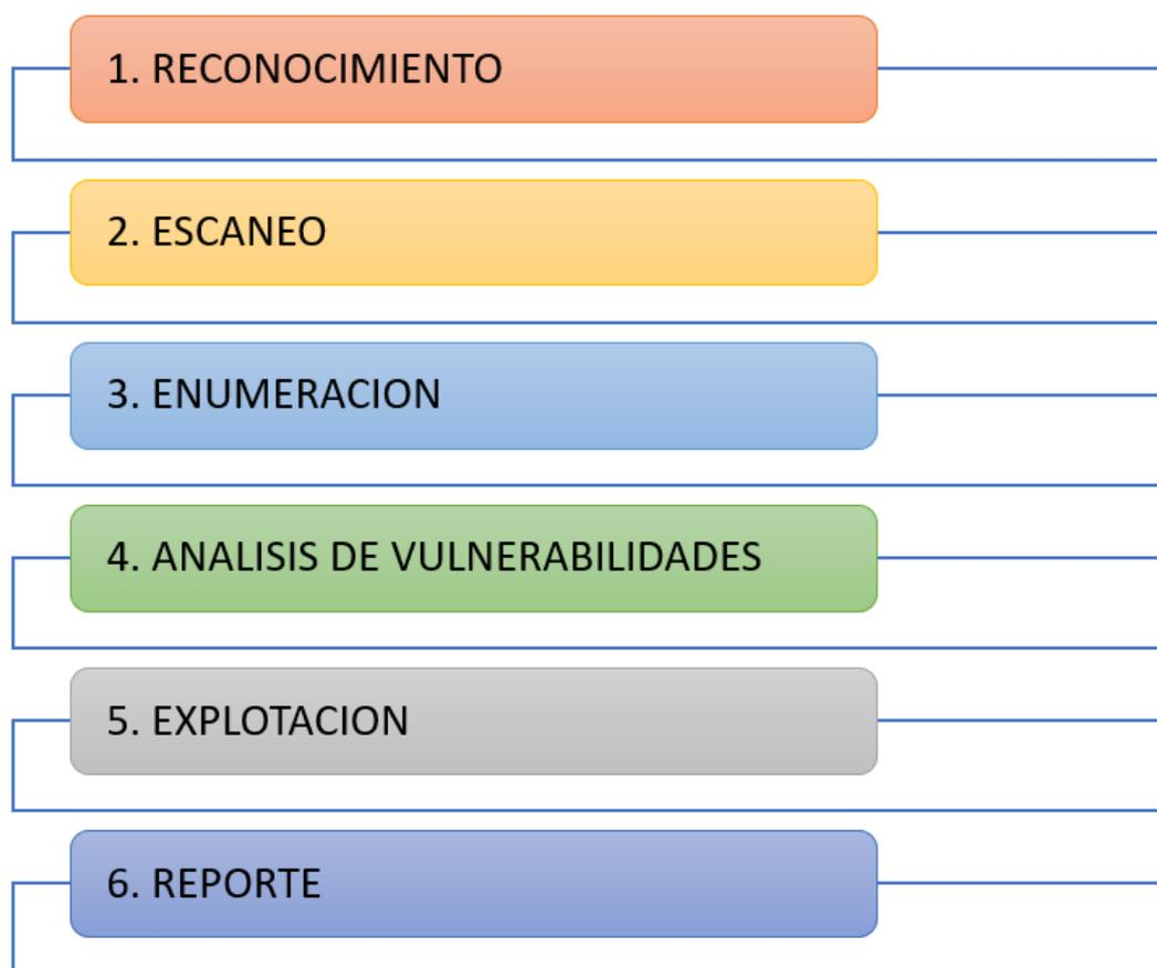
**Ilustración 21-3:** Etapas de las pruebas de penetración
