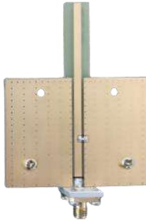
**Ilustración 3-14:** Antena monopolo
