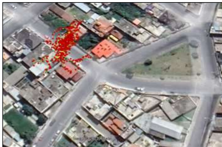
Ilustración 4-71: Toma de datos GNSS en la prueba estática utilizando el smartphone Moto G20 y Choke ring low-cost con aluminio Realizado por: Bonilla E., 2023
