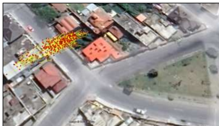
Ilustración 4-77: Toma de datos GNSS en la prueba estática utilizando el smartphone Xiaomi 11 Lite 5G – Choke ring low-cost con aluminio
