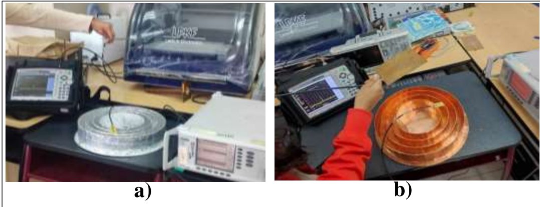
Ilustración 4-24: Escenario – patrón de radiación monopolo a L5- a) aluminio b) cobre Realizado por: Bonilla E., 2023
