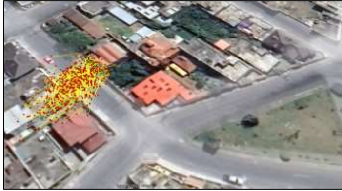
Ilustración 4-79: Toma de datos GNSS en la prueba estática utilizando el smartphone Xiaomi 11 Lite 5G - Choke ring low-cost con cobre Realizado por: Bonilla E., 2023
