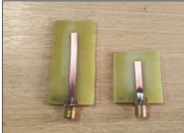
Ilustración 3-18: Antenas monopolo implementadas en la banda L de GPS. Realizado por: Bonilla E., 2023
