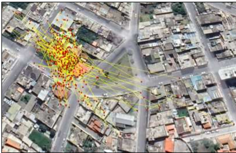
Ilustración 4-74: Toma de datos GNSS prueba estática utilizando el Smartphone Xiaomi 11 Lite 5G Realizado por: Bonilla E., 2023
