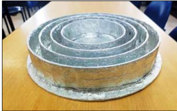
Ilustración 3-12: Estructura de la Choke ring recubierta con papel aluminio Realizado por: Bonilla E., 2023
