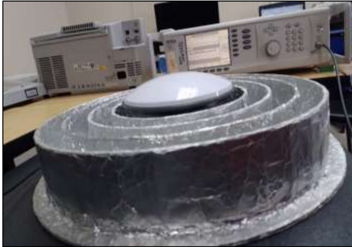
Ilustración 4-29: Escenario patrón de radiación – antena triple banda Realizado por: Bonilla E., 2023
