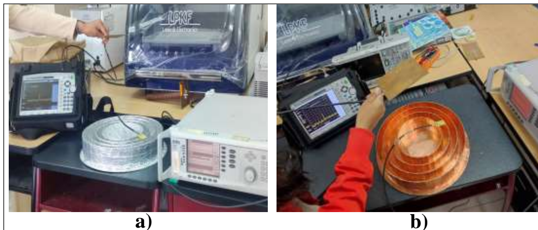
Ilustración 4-20: Escenario - patrón de radiación monopolo L1 a) Aluminio b) Cinta de cobre Realizado por: Bonilla E., 2023
