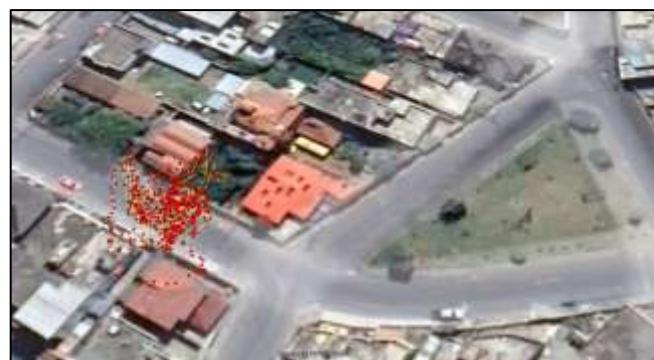
Ilustración 4-68: Datos GNSS obtenidos en prueba estática utilizando el smartphone Moto G20 Realizado por: Bonilla E., 2023
