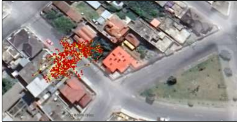
Ilustración 4-73: Toma de datos GNSS prueba estática utilizando el smartphone Moto G20-Choke ring low-cost con cobre Realizado por: Bonilla E., 2023
