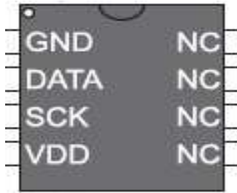
Ilustración 37-2: Conexión y Pines del sensor SHTxx
