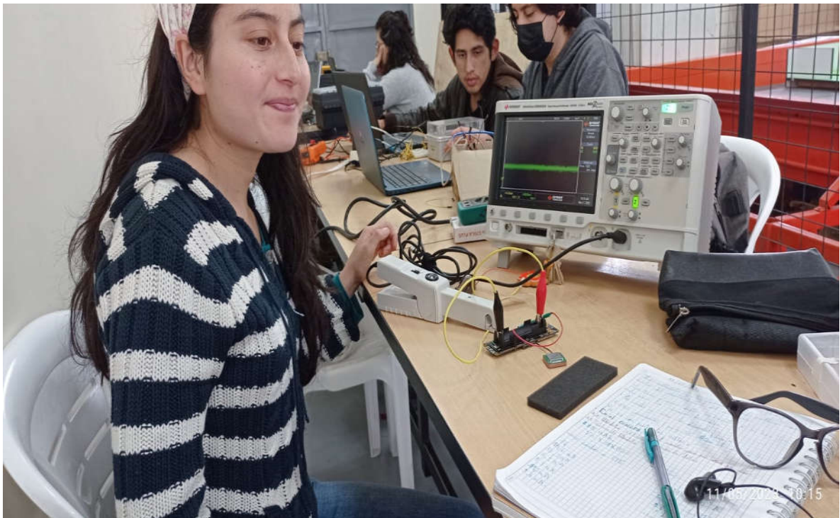
ANEXO N: Medición de la corriente con osciloscopio y punta amperimétrica.
