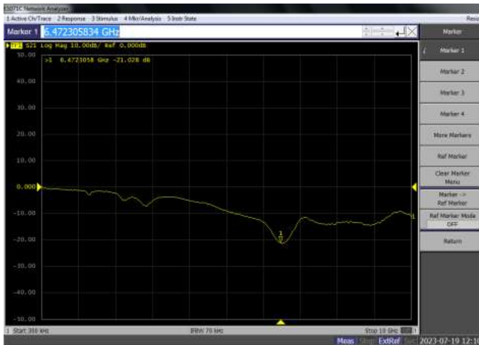
Ilustración 4-6: Medición de biosensor con una concentración de 150mg/dl de glucosa Realizado por: Parra E., 2023
