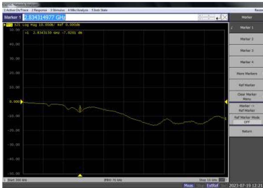
Ilustración 4-8: Medición de biosensor con una concentración de 250mg/dl de glucosa Realizado por: Parra E., 2023
