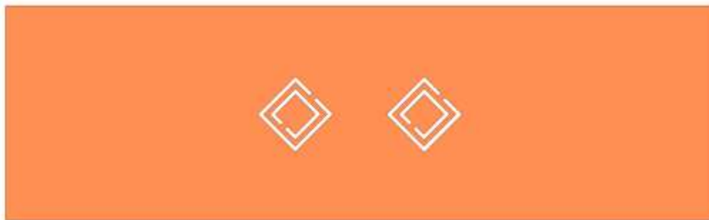
Ilustración 3-8: Resonador de anillo complementario CSRR en el sustrato. Realizado por: Parra E., 2023
