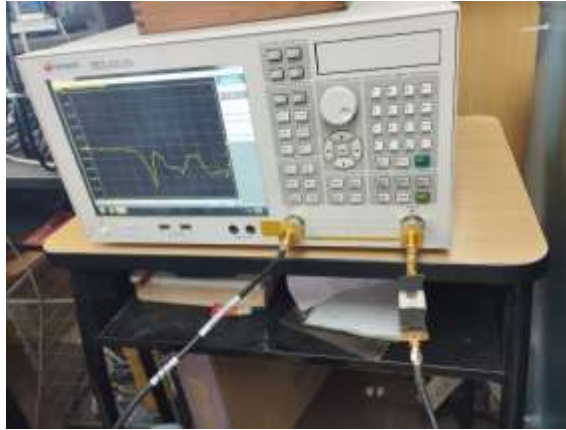
Ilustración 4-2: Toma de datos del Biosensor con el VNA Realizado por: Parra E., 2023
