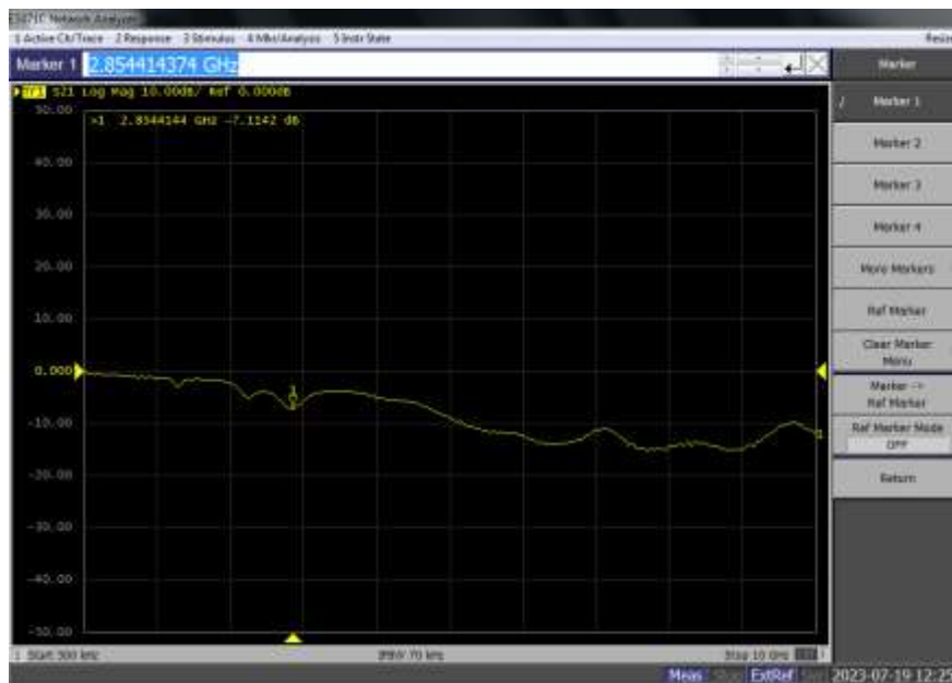
Ilustración 4-9: Medición de biosensor con una concentración de 300mg/dl de glucosa Realizado por: Parra E., 2023
