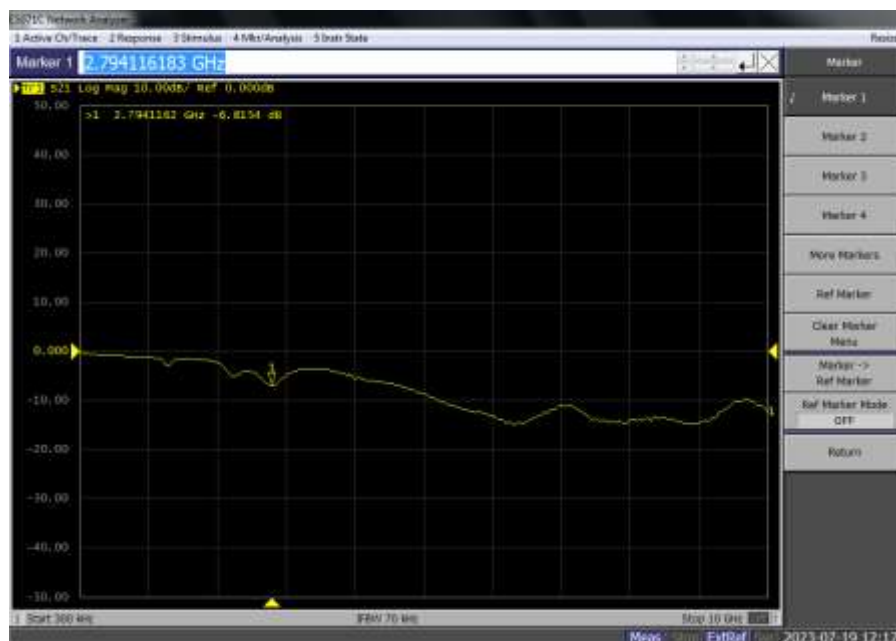
Ilustración 4-7: Medición de biosensor con una concentración de 200mg/dl de glucosa Realizado por: Parra E., 2023
