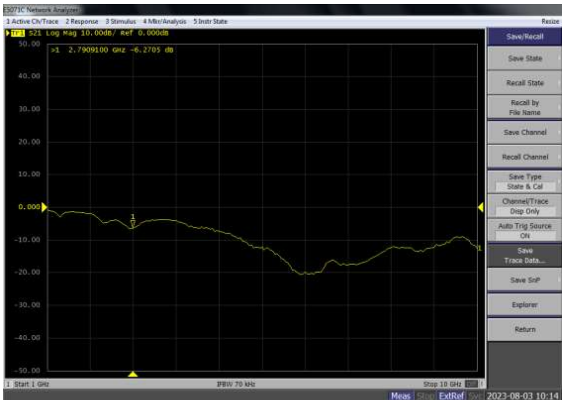
Ilustración 4-5: Medición de biosensor con una concentración de 100mg/dl de glucosa.
