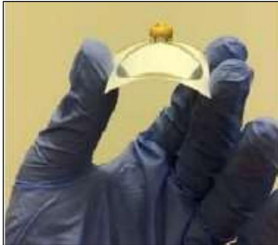
**Ilustración 2-15:** Antena dipolo doblada ranurada
