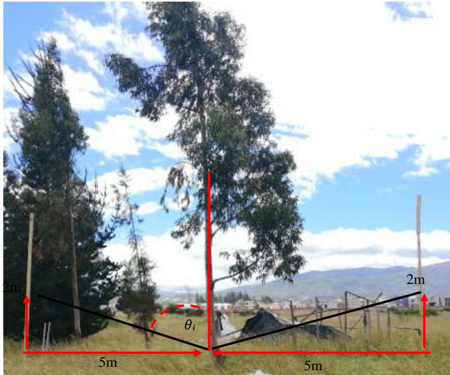
**Ilustración 4-9:** Geometría de reflexión del árbol de eucalipto a 2 metros.
