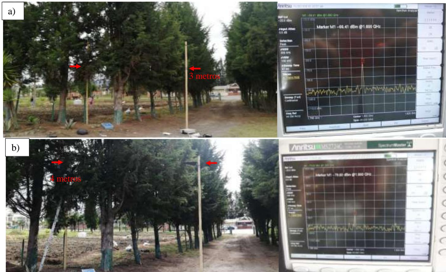
**Ilustración 3-47:** Medición de la potencia atenuada en el bosque de ciprés para el primer árbol a 1.8 GHz con altura de la antena (a) 4 metros (b) 4 metros.
