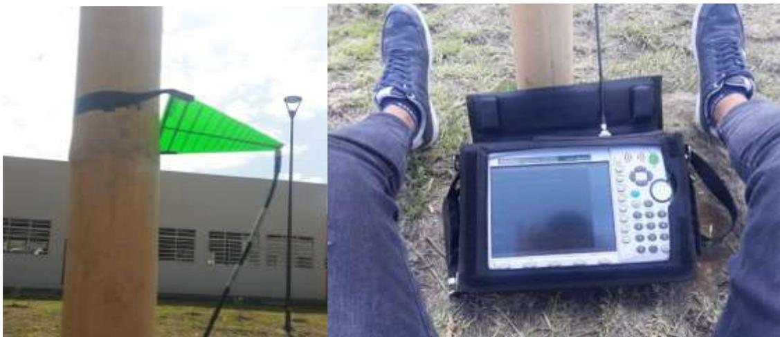
**Ilustración 3-12:** Analizador de espectro Anritsu y antena logarítmica.
