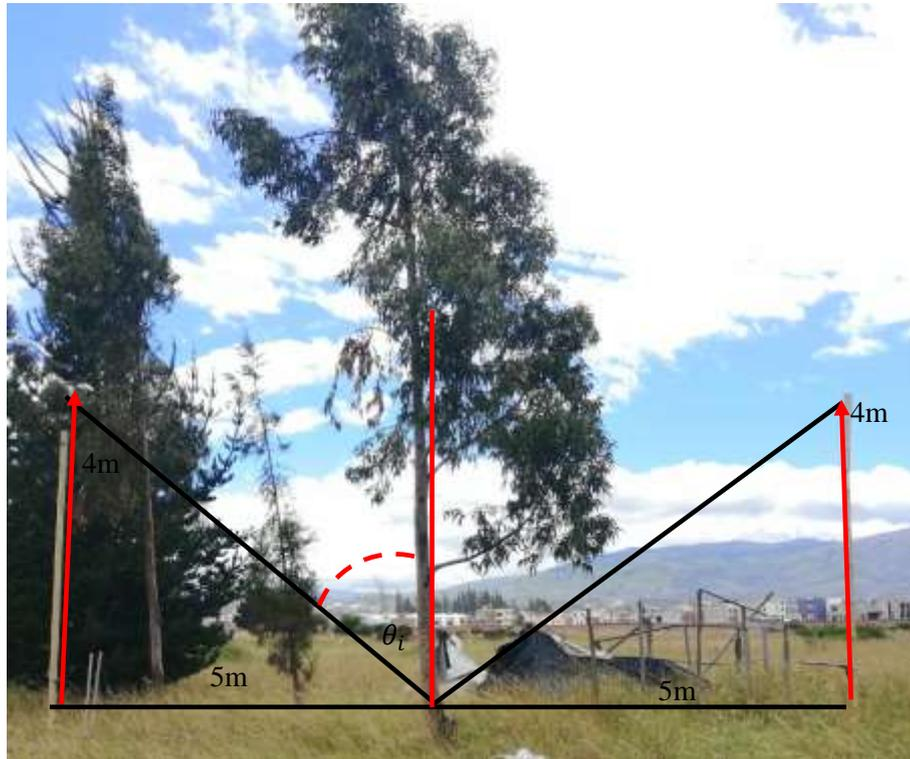
**Ilustración 4-12:** Geometría de reflexión del árbol de eucalipto a 4 metros.
