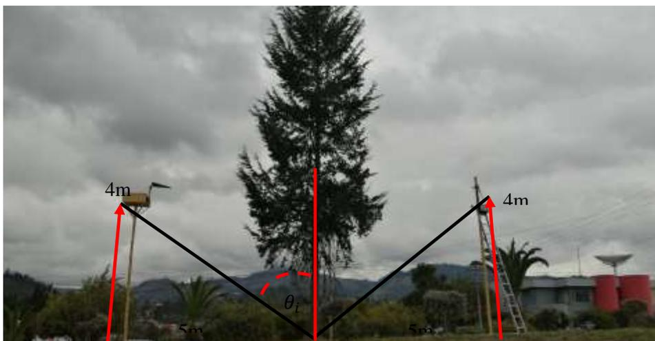
**Ilustración 4-19:** Geometría de reflexión del árbol de ciprés a 4 metros.
