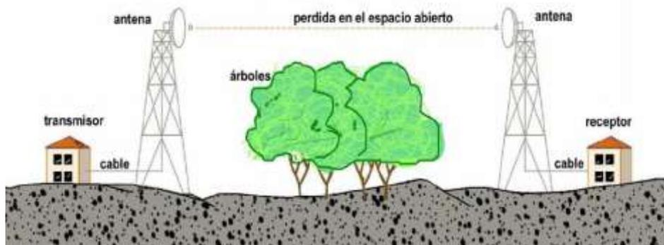
**Ilustración 2-13:** Trayectoria de una onda de radio entre transmisor y receptor.
