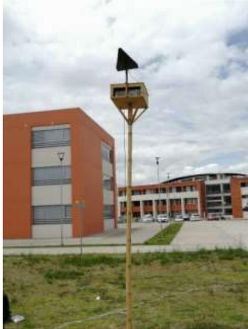
**Ilustración 3-10:** Transmisión del generador de señales y antena logarítmica en el espacio libre.
