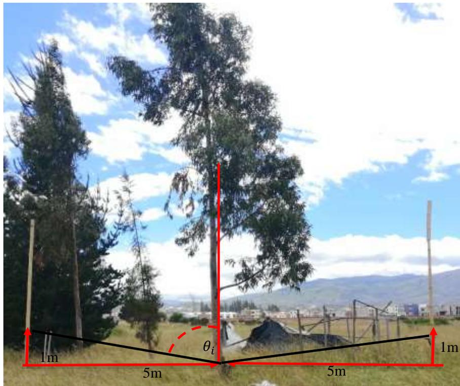
**Ilustración 4-8:** Geometría de reflexión del árbol de eucalipto a 1 metro.
