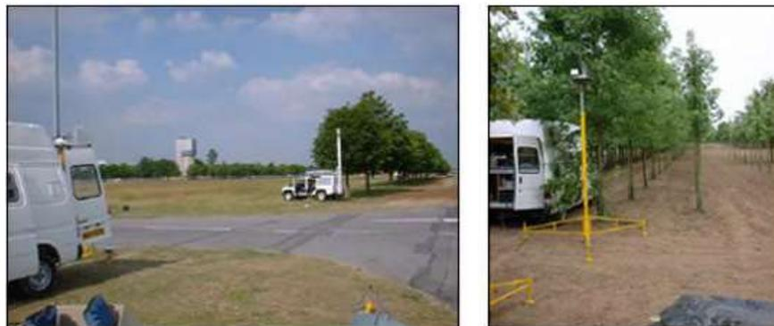
**Ilustración 2-15:** Montaje experimental utilizado para mediciones de atenuación por vegetación.
