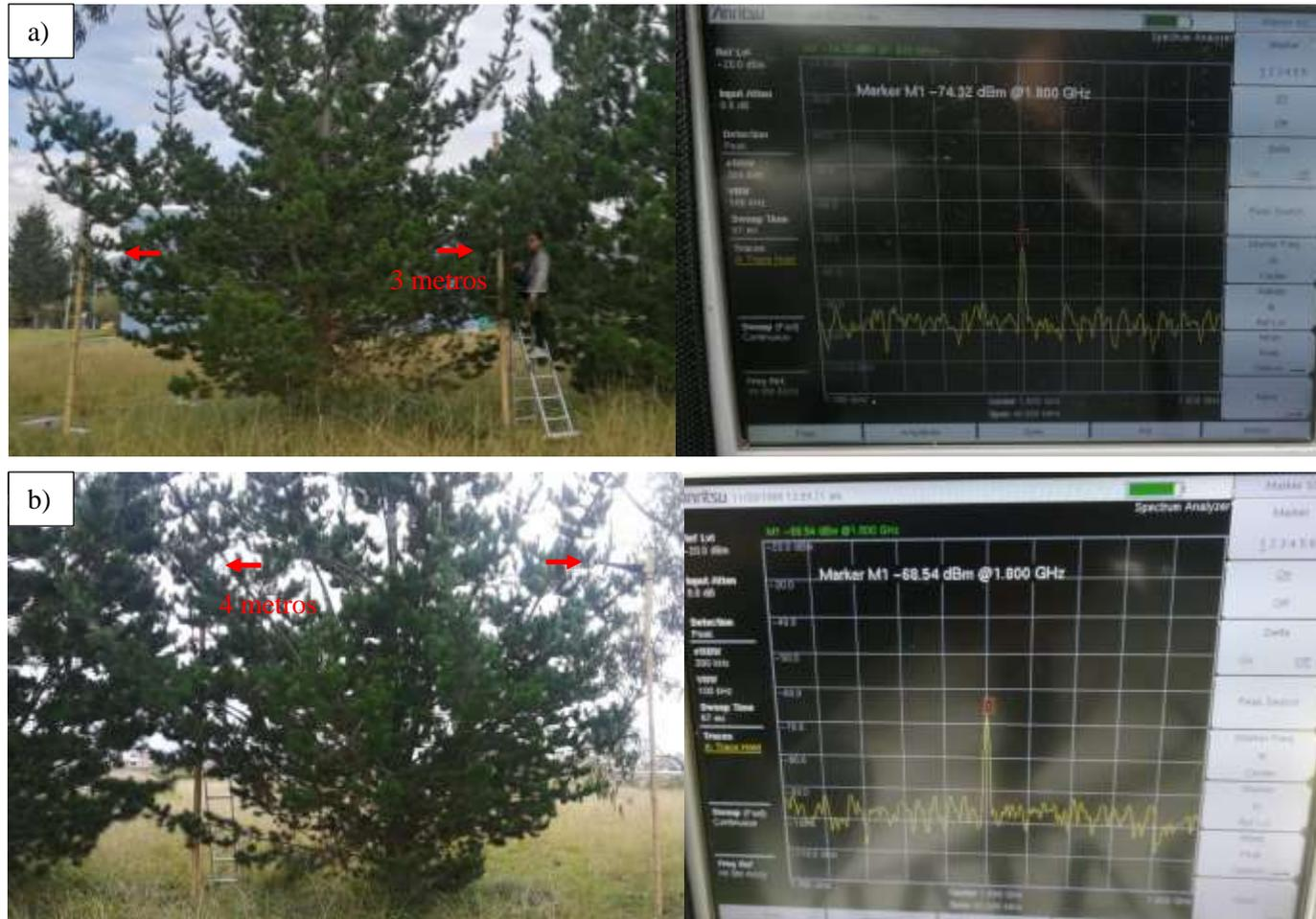
**Ilustración 3-29:** Medición de la potencia atenuada en el bosque de pino para el primer árbol a 1.8 GHz con altura de la antena (a) 3 metros (b) 4 metros.
