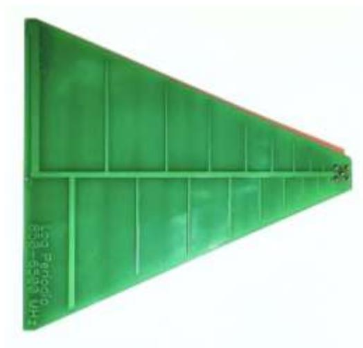
**Ilustración 3-13:** Antena Log Periodic WA5VJB 850 a 6500 MHz.
