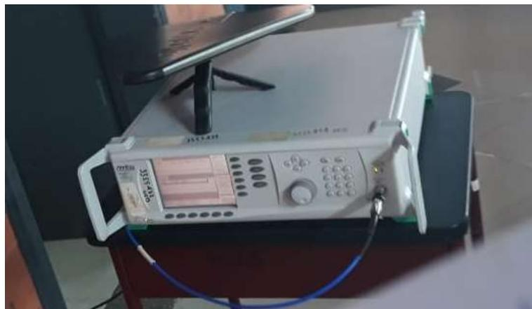
**Ilustración 3-9:** Generador de señales Anritsu y antena logarítmica.
