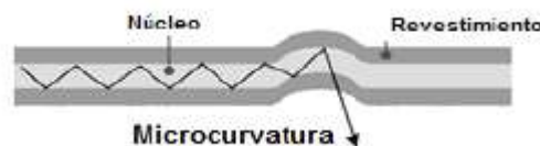
Ilustración 2-7: Pérdidas por Microcurvaturas.
