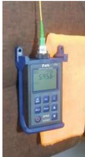
Ilustración 3-15: Valor de potencia en condiciones normales de la fibra 3.
