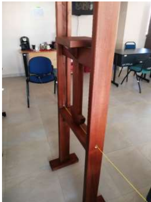
Ilustración 3-11: Instalación de la fibra óptica.
