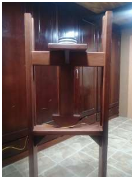
Ilustración 3-7: Dispositivo para ejercer presión mediante peso.
