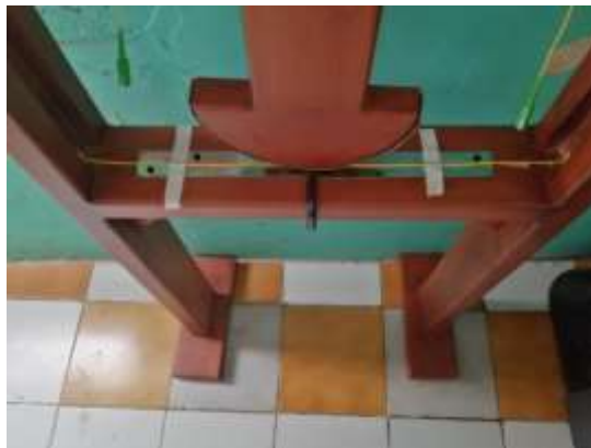
Ilustración 3-9: Reducción de contacto con la fibra por medio de trozo de varilla hexagonal.
