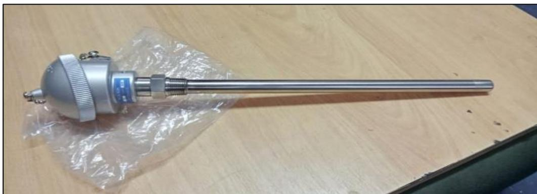
**Ilustración 3-1:** Termopozo en acero inoxidable 316, conexión roscada al elemento sensor.
