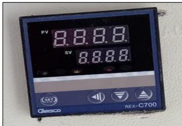
**Ilustración 3-3:** Controlador de temperatura REX-C700
