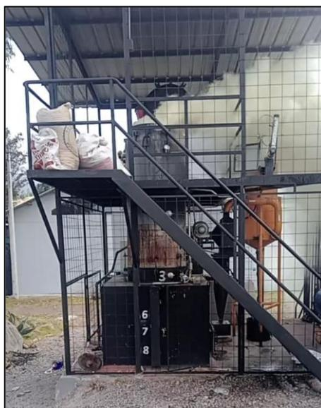
**Ilustración 2-9:** Gasificador downdraft
