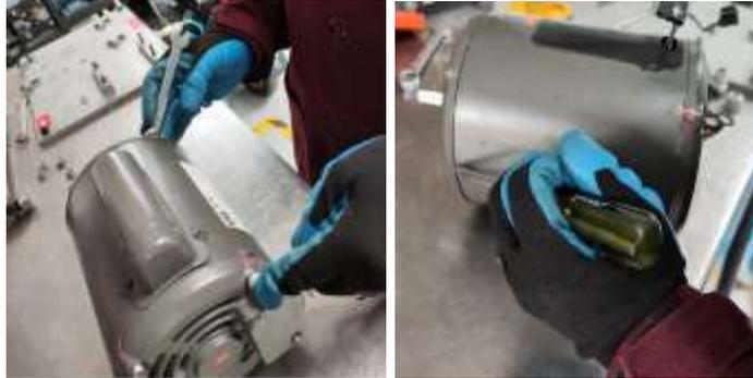
**Ilustración 13:** Desmontaje de las tapas del motor.
