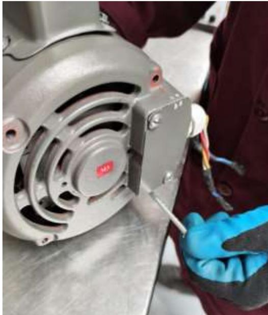
**Ilustración 16:** Ajuste de los pernos del motor
