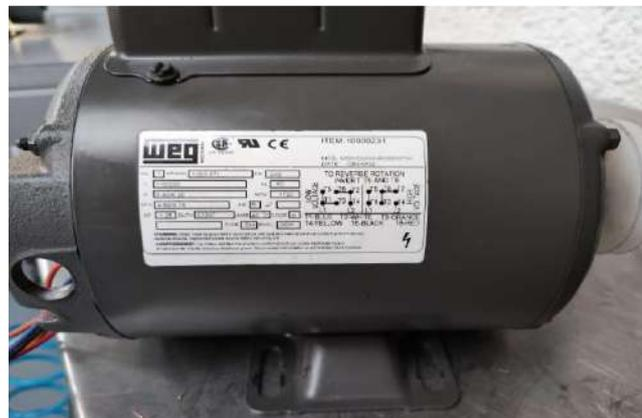
**Ilustración 3-23:** Motor monofásico
