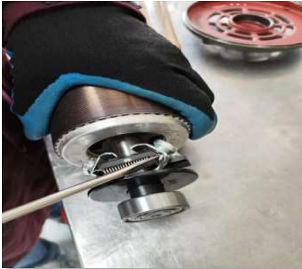
**Ilustración 5:** Montaje del Interruptor centrífugo
