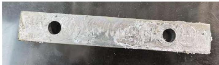
**Ilustración 3-36:** Mecanizado de los orificios de las bases del motor
