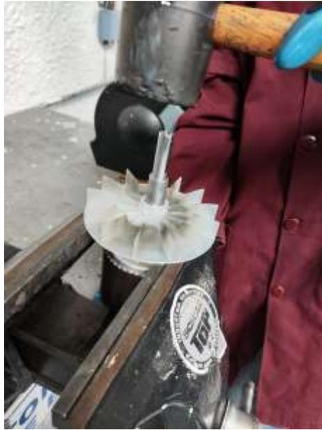
**Ilustración 7:** Montaje del ventilador
