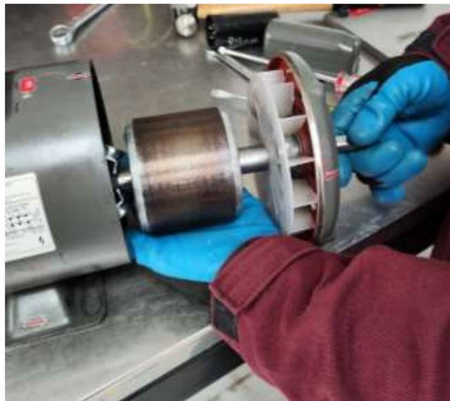
**Ilustración 7:** Montaje del rotor en el motor
