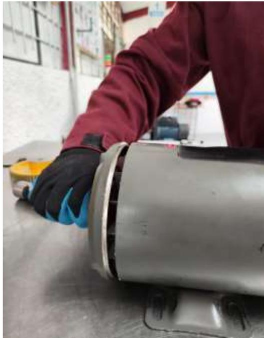
**Ilustración 9:** Montaje de la tapa delantera del motor
