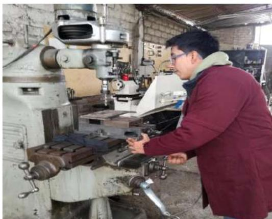
**Ilustración 3-34:** Mecanizado de las bases desmontables
