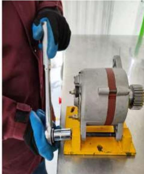
**Ilustración 8:** Desajuste del perno sin fin
