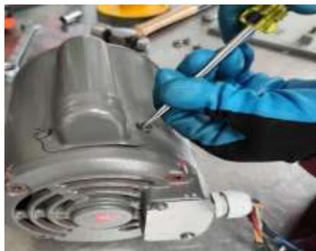
**Ilustración 12:** Desmontaje del condensador.
