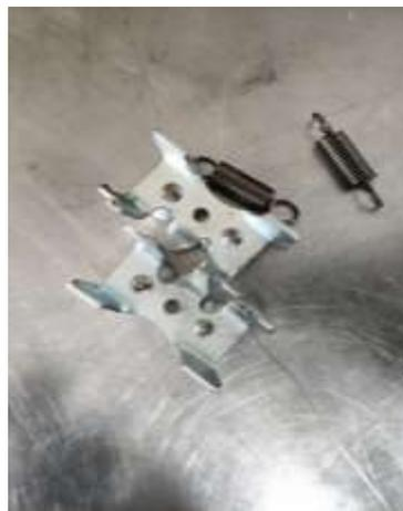
**Ilustración 4:** Interruptor centrífugo.
