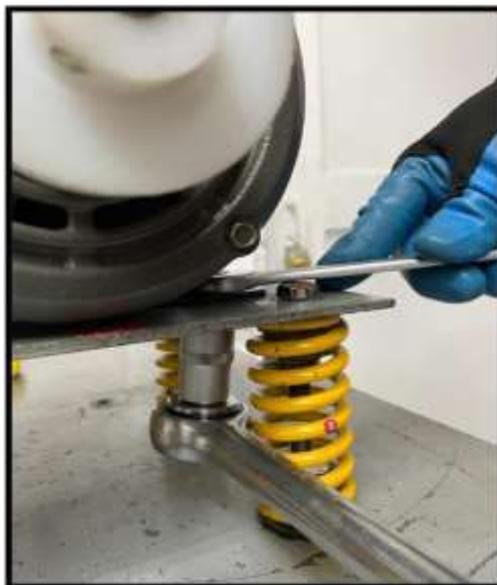
**Ilustración 31:** Ajuste del motor a la placa de resortes
