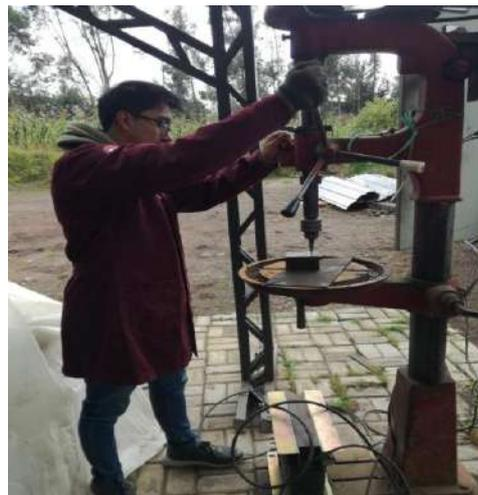
**Ilustración 3-32:** Mecanizado de orificios en la base
