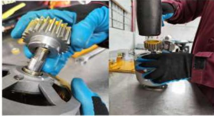
**Ilustración 12:** Montaje del piñón en el eje del alternador
