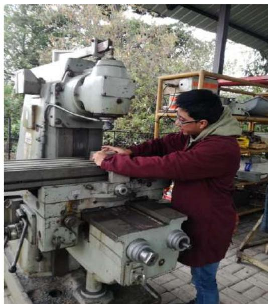
**Ilustración 3-30:** Mecanizado de la placa fija
