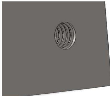
**Ilustración 3-14:** Rosca de la placa base fija
