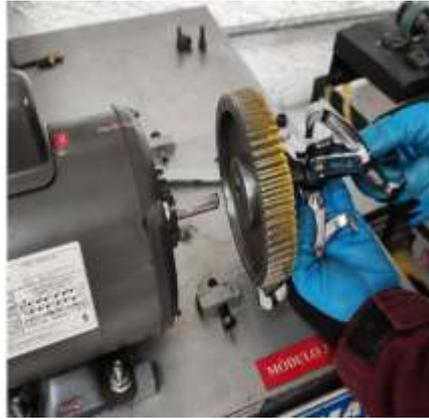
**Ilustración 10:** Retiro del engranaje del motor.
