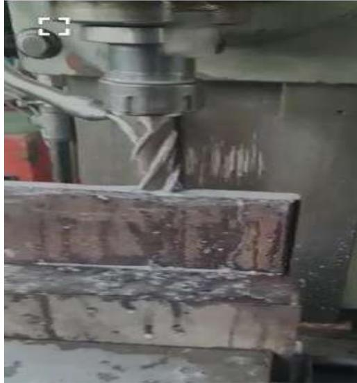
**Ilustración 3-31:** Mecanizado placa móvil
