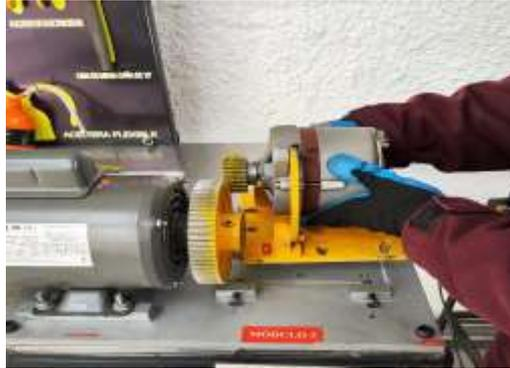
**Ilustración 15:** Montaje de la base del alternador
