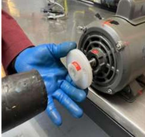
**Ilustración 30:** Ensamble de la polea al motor
