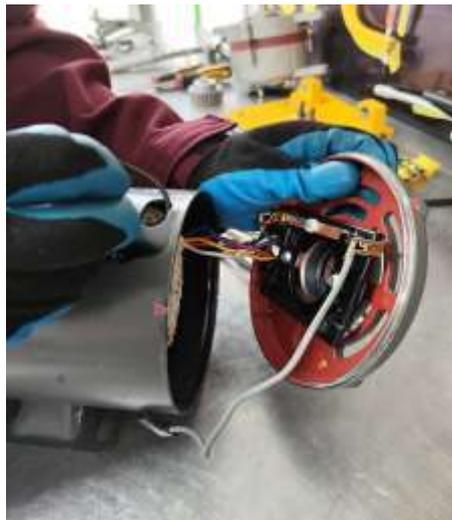
**Ilustración 12:** Montaje de la tapa trasera del motor
