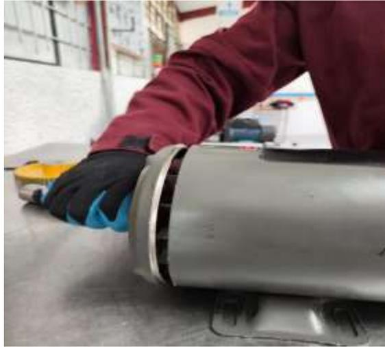
**Ilustración 13:** Montaje de la tapa delantera del motor
