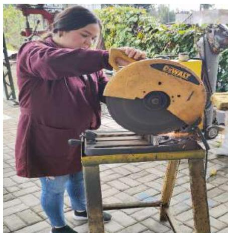
**Ilustración 3-37:** Corte acero para bases alternador
