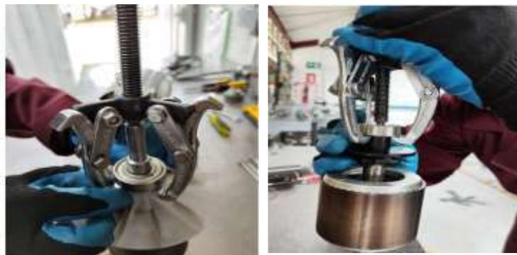
**Ilustración 17:** Desmontaje de rodamiento.
