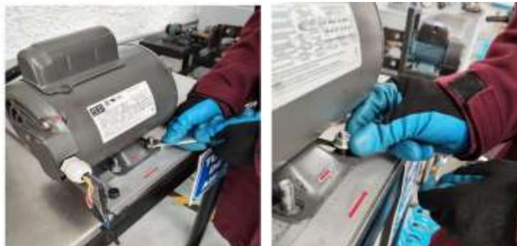
**Ilustración 11:** Desajuste de las tuercas del motor.
