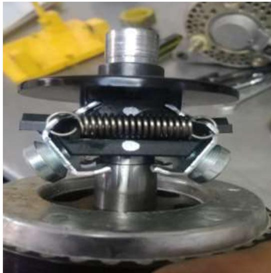
**Ilustración 6:** Montaje del Interruptor centrífugo
