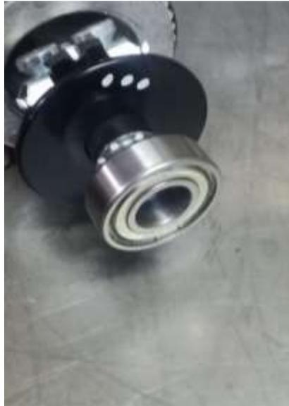
**Ilustración 6:** Montaje del rodamiento 6202 Z
