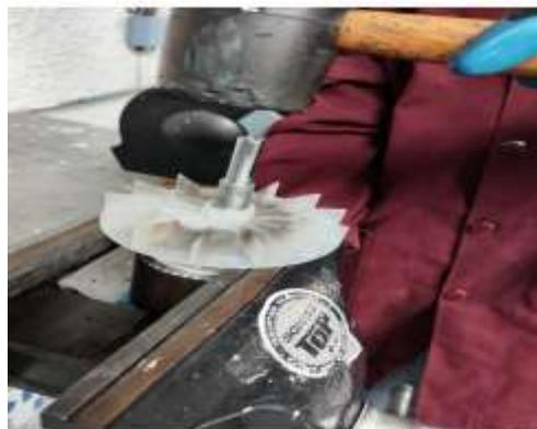
**Ilustración 18:** Desmontaje del ventilador
