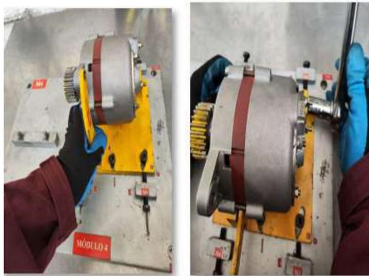
**Ilustración 25:** Ensamble del alternador a la base
