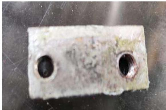
**Ilustración 3-41:** Mecanizado de los orificios
