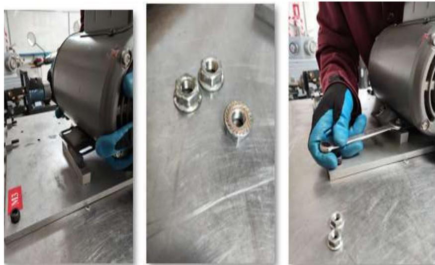
**Ilustración 29:** Ensamble del motor a la base
