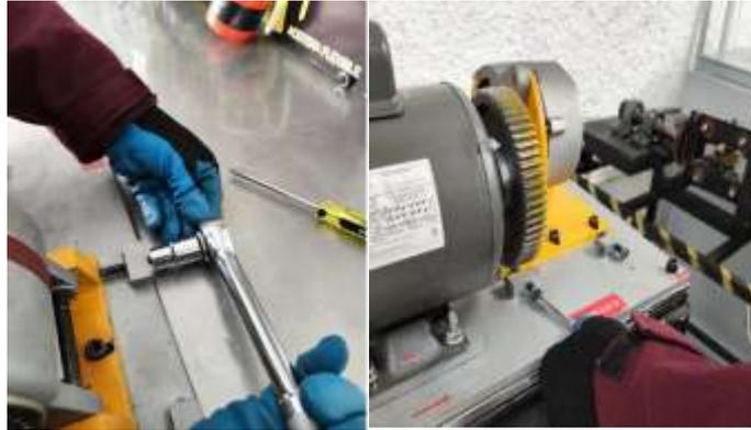
**Ilustración 5:** Retiro de los pernos de sujeción.
