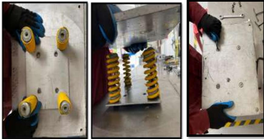
**Ilustración 26:** Ensamble de los resortes
