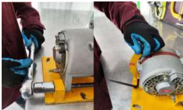
**Ilustración 14:** Montaje del alternador a la base
