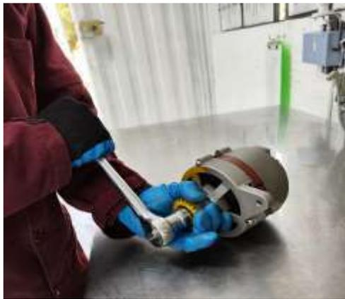
**Ilustración 13:** Ajuste del piñón
