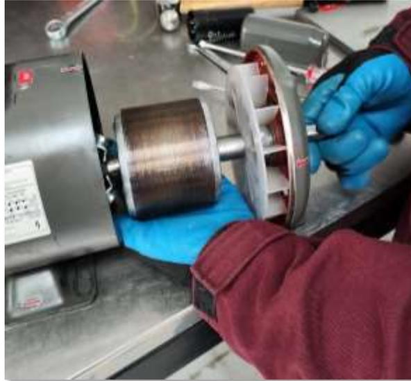
**Ilustración 11:** Montaje del rotor en el motor
