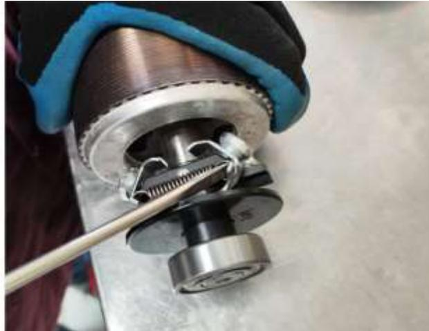
**Ilustración 19:** Desmontaje del interruptor centrífugo.
