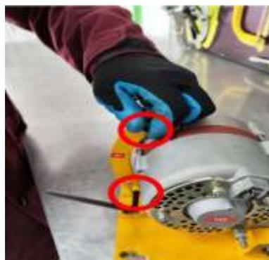
**Ilustración 7:** Desajuste de la base circular.
