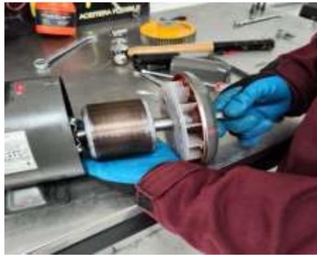
**Ilustración 16:** Retiro del rotor del motor
