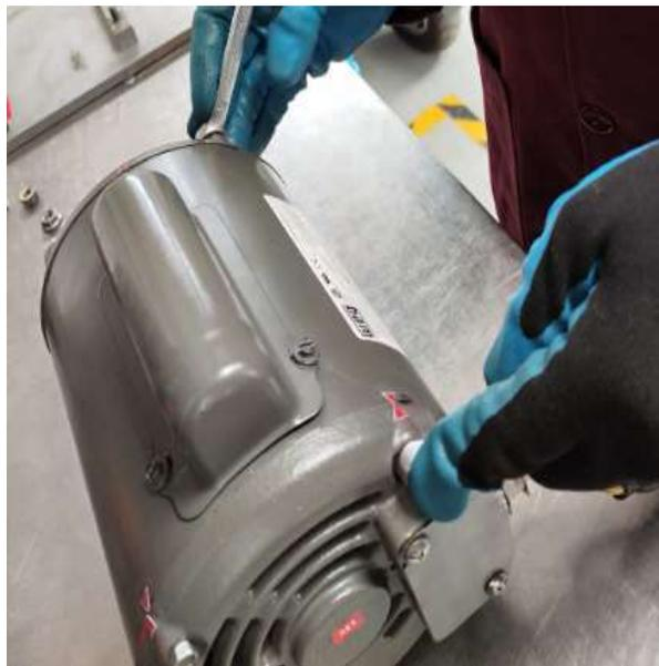
**Ilustración 17:** Ajuste de pernos
