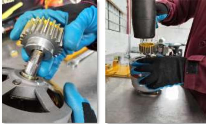
**Ilustración 24:** Ensamblaje del piñón.
