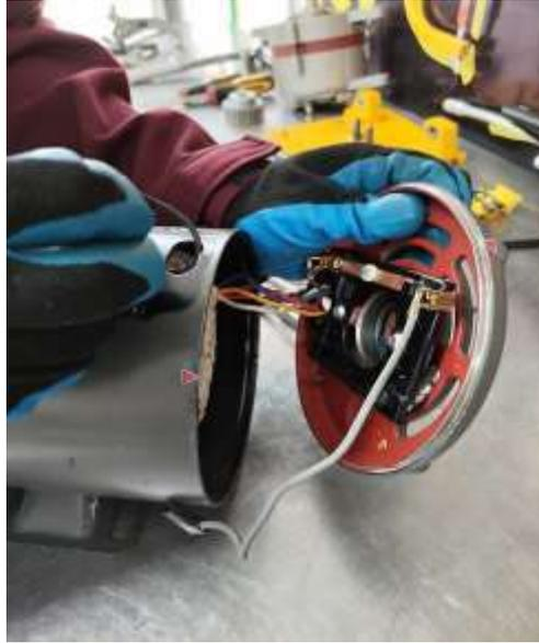
**Ilustración 8:** Montaje de la tapa trasera del motor
