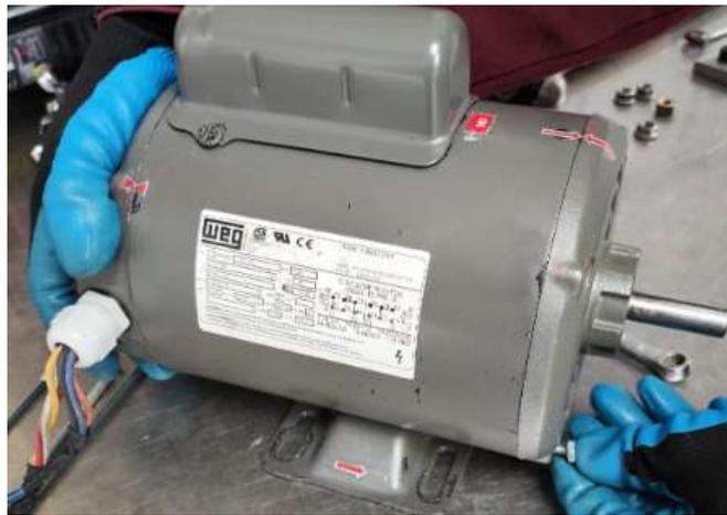
**Ilustración 2:** Motor monofásico.
