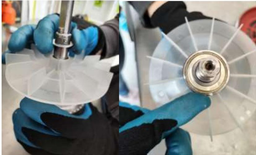
**Ilustración 4:** Montaje del rodamiento 6203 Z
