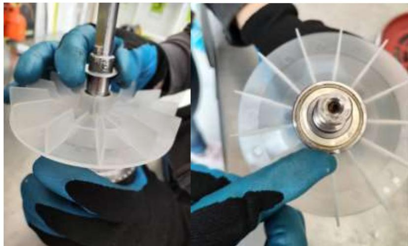
**Ilustración 8:** Montaje del rodamiento 6203 Z
