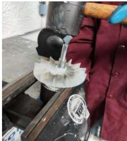
**Ilustración 3:** Montaje del ventilador
