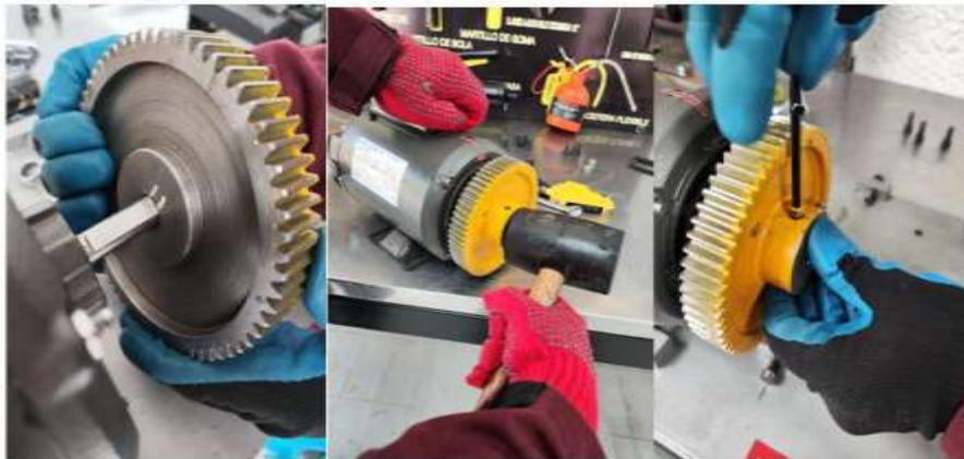
**Ilustración 11:** Montaje del engranaje en el eje del motor
