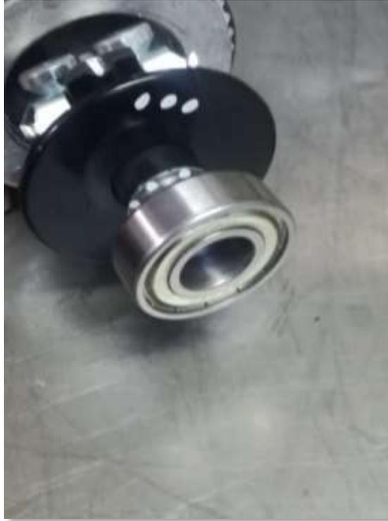
**Ilustración 9:** Montaje del rodamiento 6202 Z
