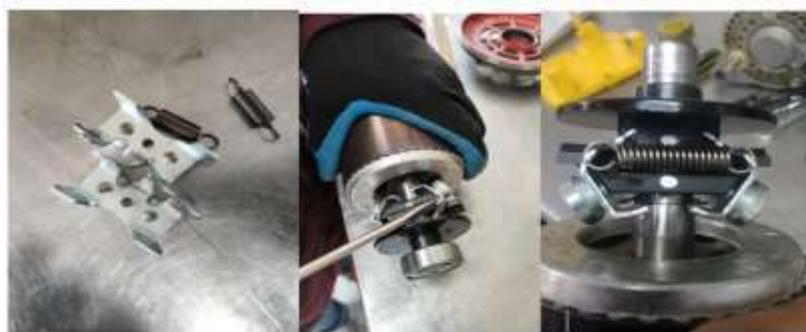
**Ilustración 5:** Montaje del Interruptor centrífugo
