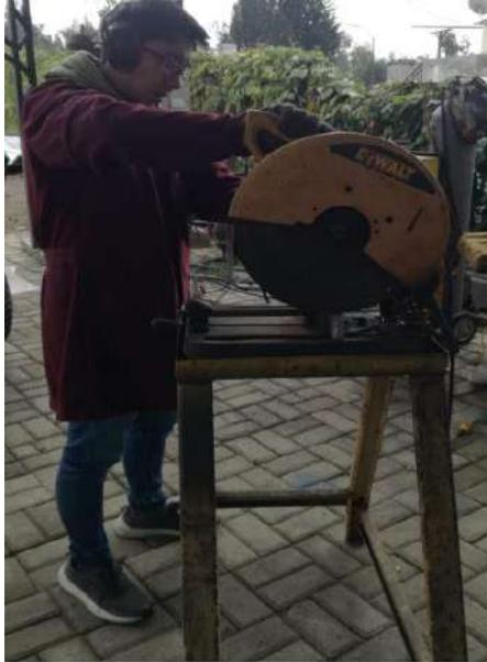
**Ilustración 3-33:** Corte del acero ASTM A36
