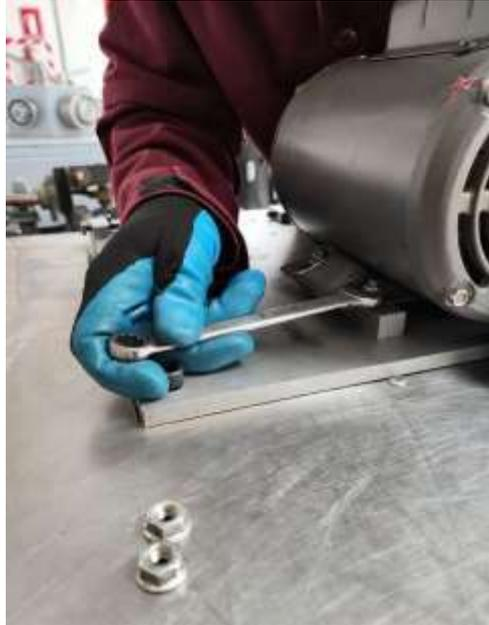
**Ilustración 10:** Ajuste de los pernos del motor
