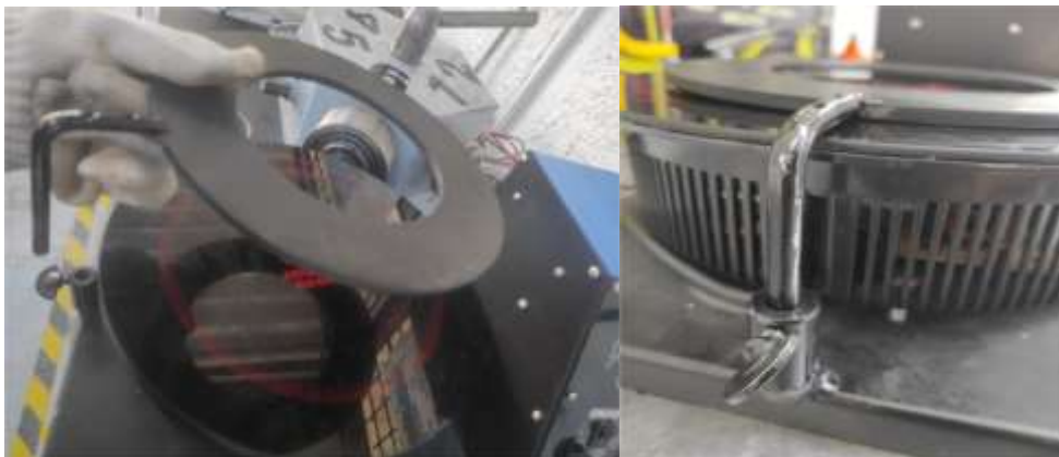
Ilustración 9. Colocar el seguro del aro de inducción.
