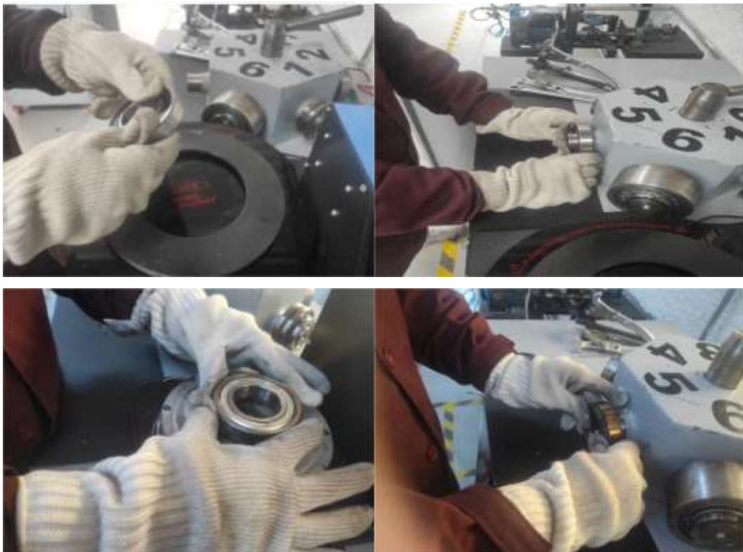
Ilustración 19. Montaje de rodamientos.
