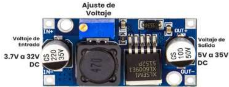
Ilustración 3-16: Regulador de voltaje DC/DC Booster Step Up XL6009
