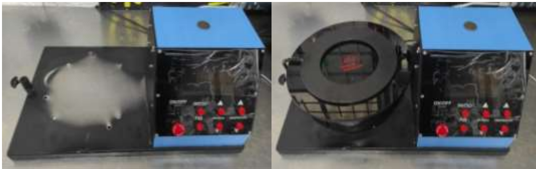
Ilustración 3-38: Proceso de montaje de piezas en base principal
