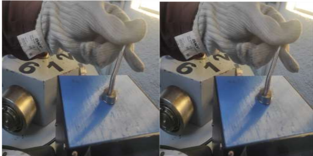
Ilustración 18. Colocación de la sonda magnética en su posición inicial.
