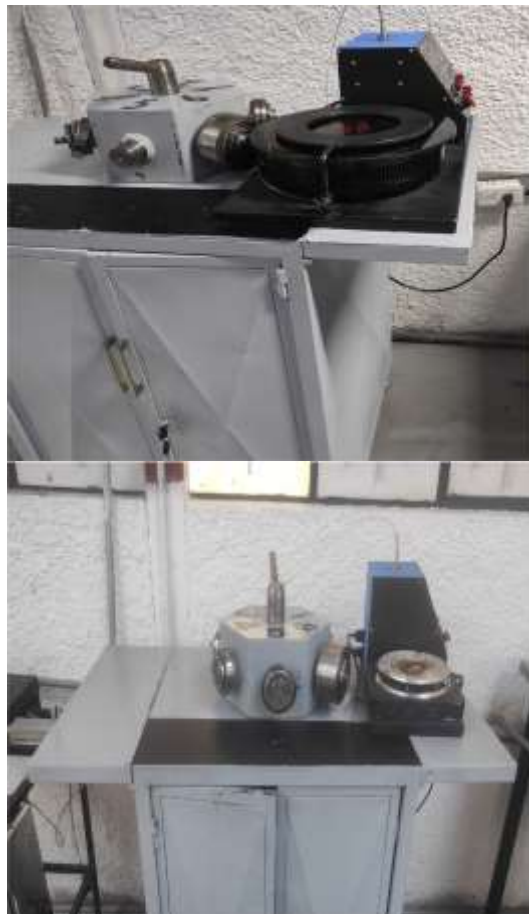
Ilustración 5. Colocación de los calentadores en los laterales de los módulos
