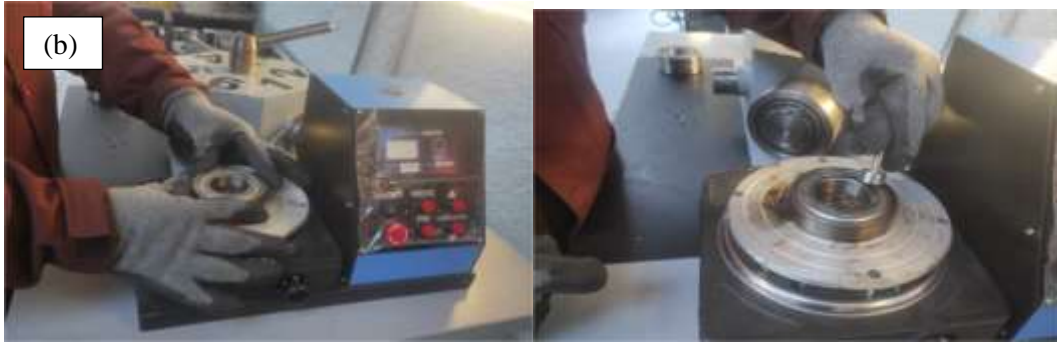
Ilustración 13. Colocación de los rodamientos en las bases del calentador inductivo y resistivo.
