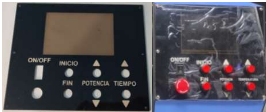
Ilustración 3-37: Máscara y portada para el sistema de control
