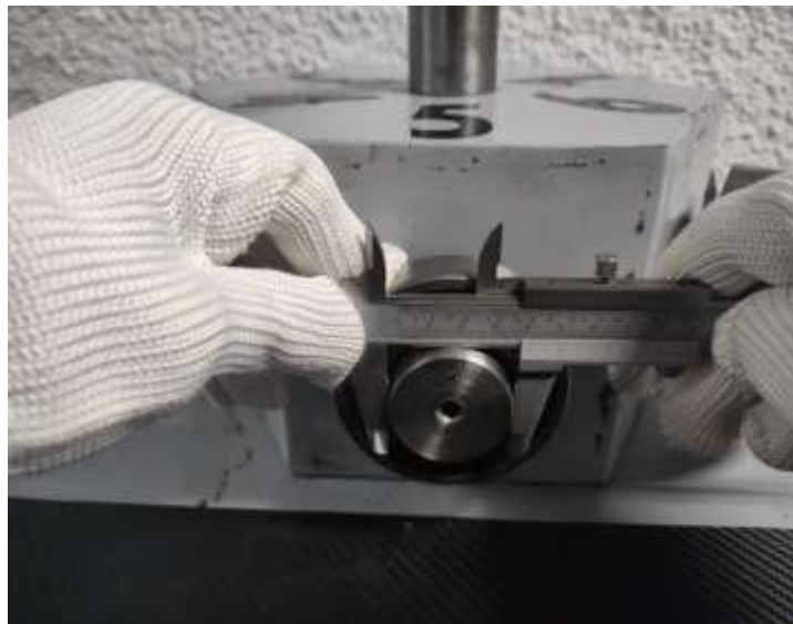
Ilustración 3-1: Toma de medida de diámetro de eje
