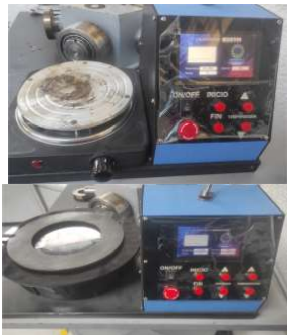
Ilustración 11. Encendido del calentador inductivo y resistivo.
