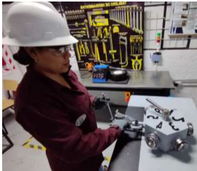
Ilustración 8. desmontaje de rodamientos.
