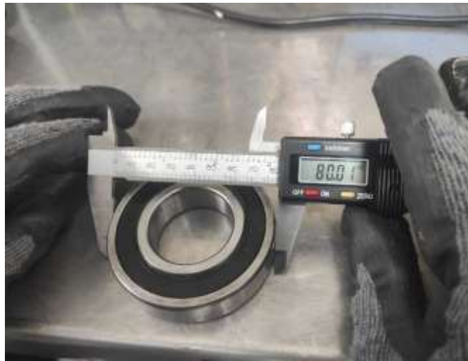
Ilustración 3-4: Rodamiento de 80 mm de diámetro externo
