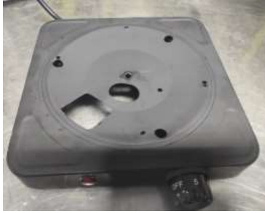
Ilustración 3-41: Estructura para resistencia eléctrica
