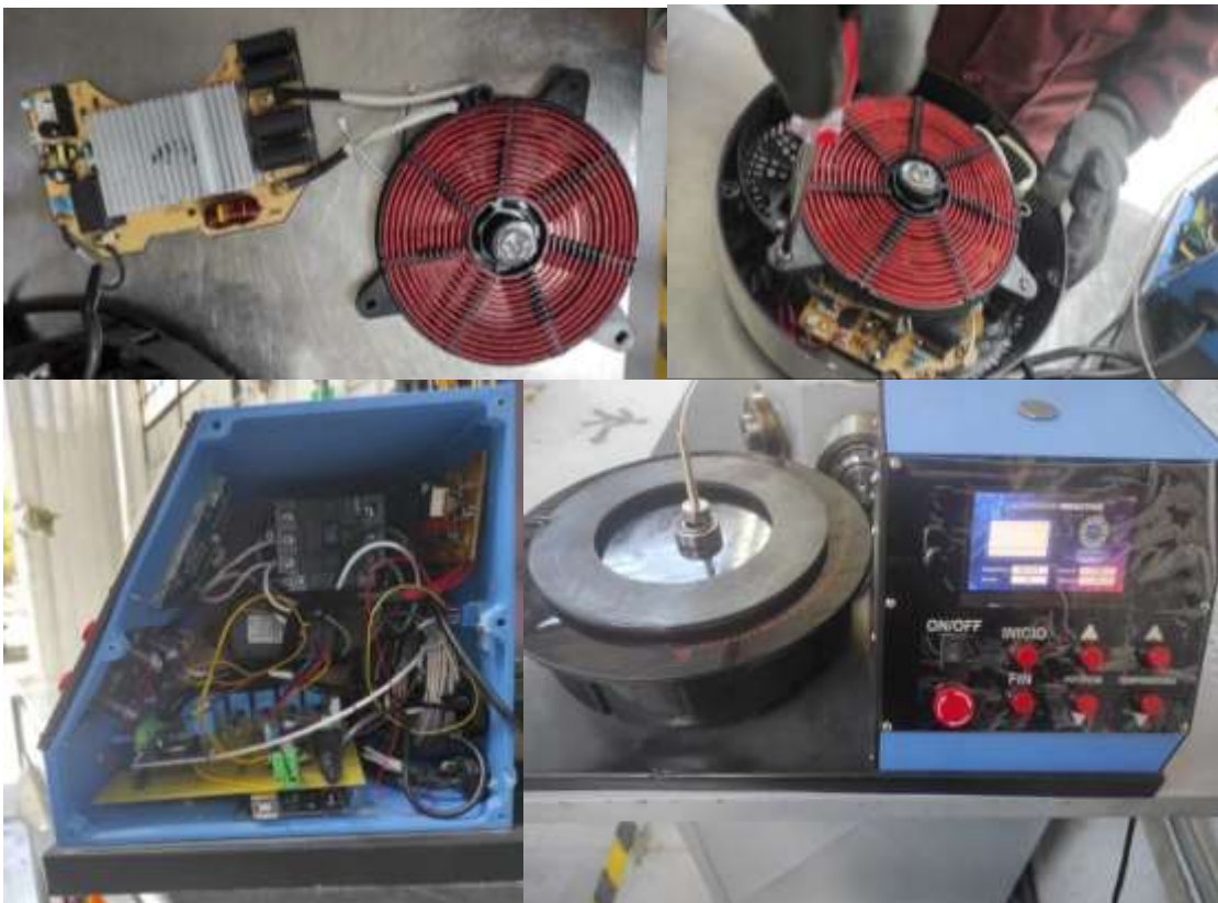
Ilustración 3-39: Proceso de montaje de sistema eléctrico y electrónico
