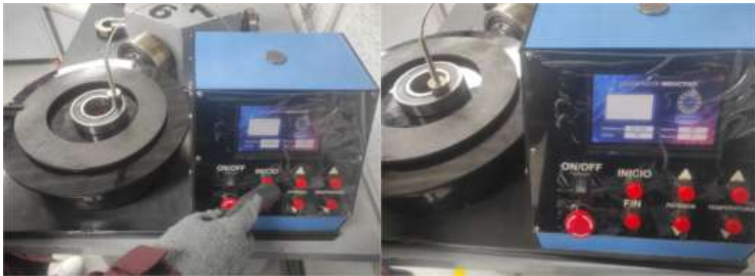
Ilustración 14. Inicio de calentamiento en el calentador inductivo.
