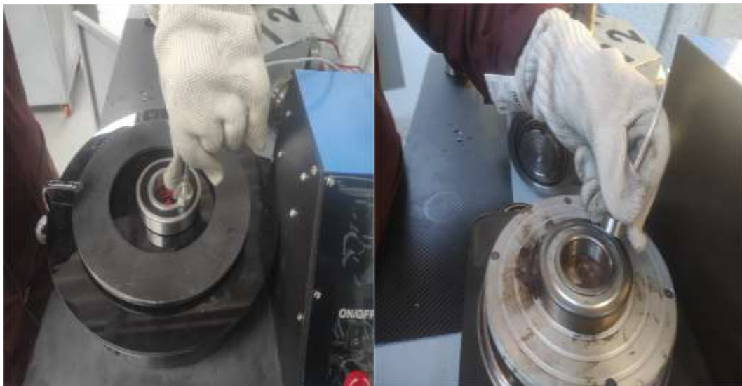
Ilustración 17. Separar la sonda magnética de la pista interna del rodamiento
