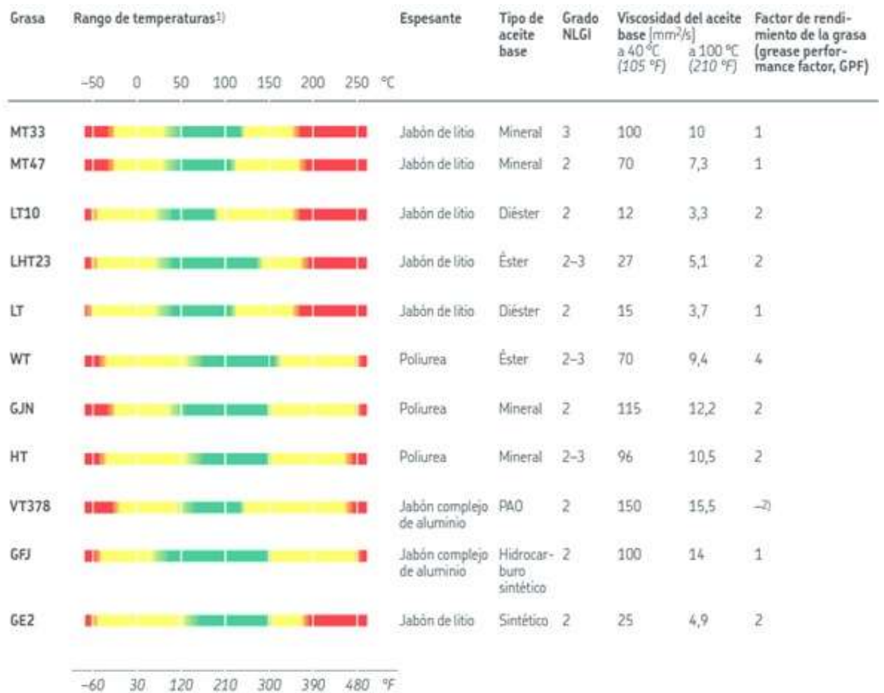
Ilustración 21. Límites de temperatura de lubricantes
