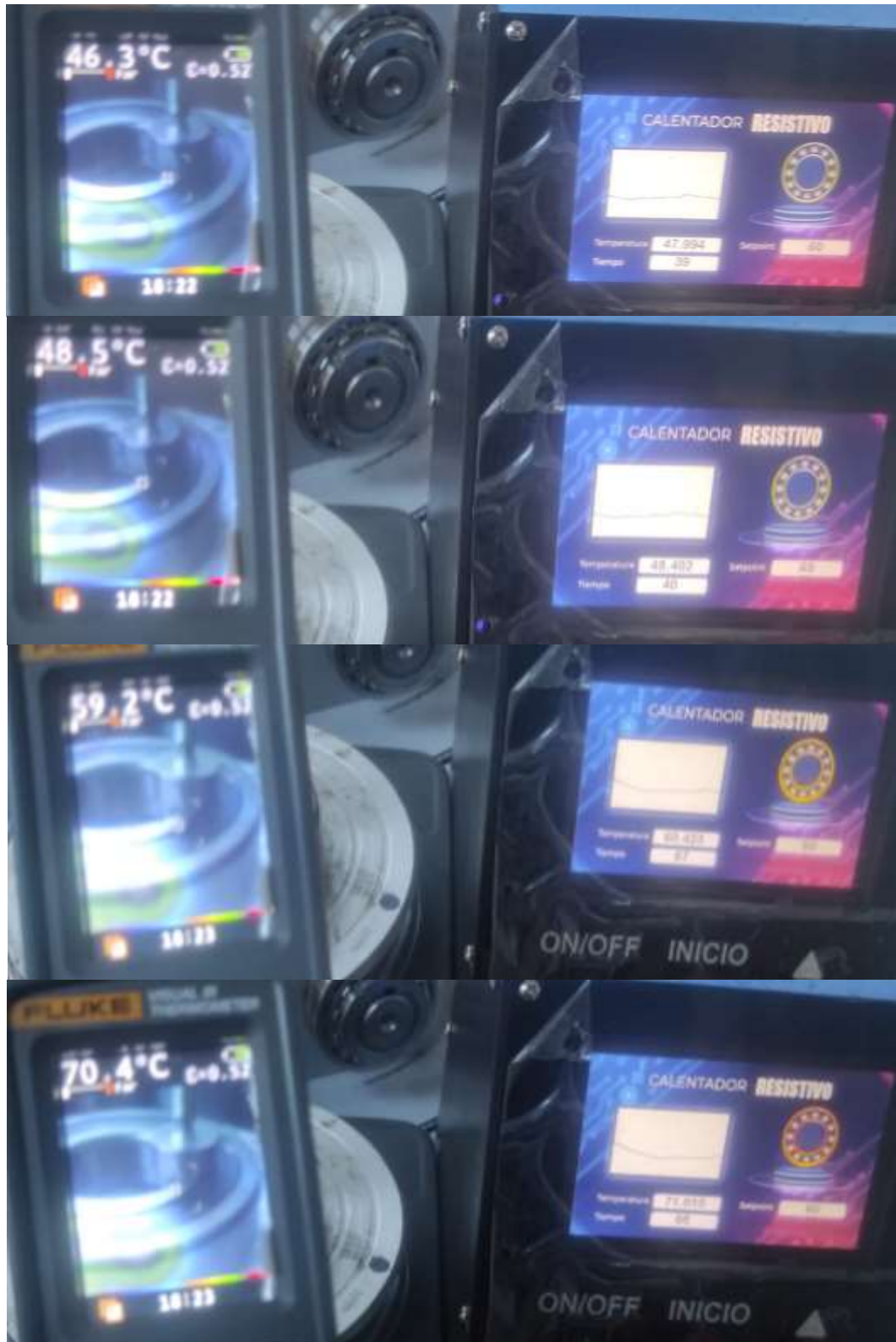
Ilustración 4-4: Mediciones calentador de rodamientos resistivo
