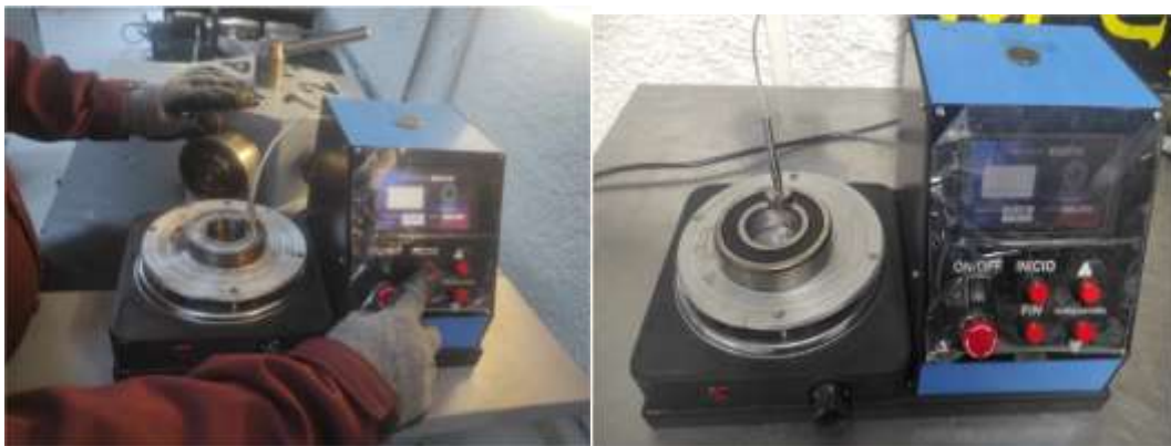
Ilustración 15. Inicio de calentamiento en el calentador resistivo.
