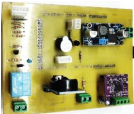
Ilustración 3-31: Tarjeta de control del calentador resistivo
