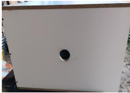
Ilustración 3-8: Parte posterior con la perforación del drenaje.
