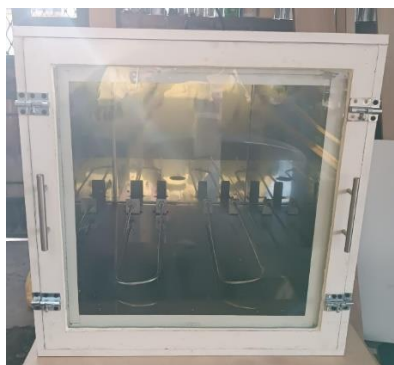
Ilustración 3-6: Puerta de la cámara de corrosión.
