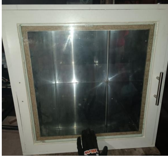
Ilustración 3-5: Cuerpo de la cámara de corrosión.
