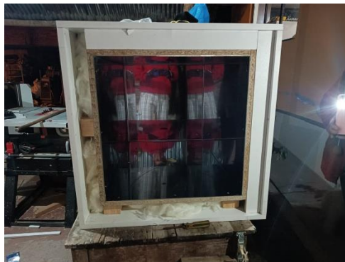
Ilustración 3-7: Cubierta externa de la cámara.
