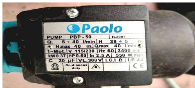
Ilustración 3-34: Especificaciones de bomba de agua reemplazada
