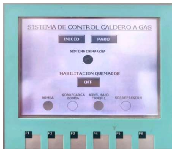
Ilustración 3-56: Control inicial de funcionamiento de bomba de agua
