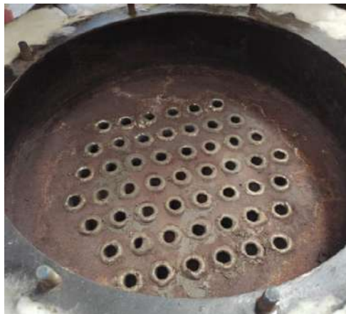
Ilustración 3-6: Tubos de calor
