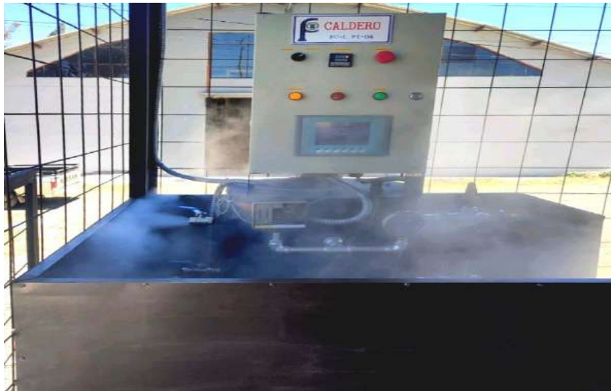
Ilustración 3-52: Prueba 2 válvulas de vapor abrita a la mitad
