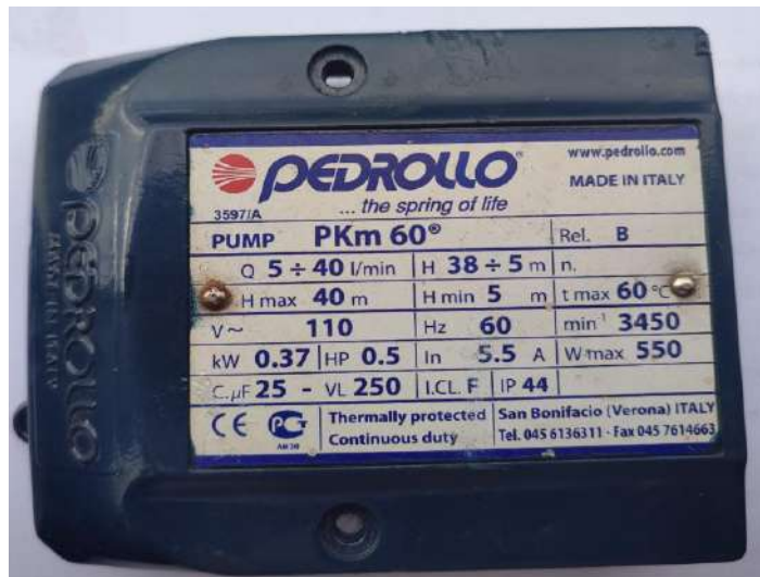
Ilustración 3-2: Especificación de bomba de agua
