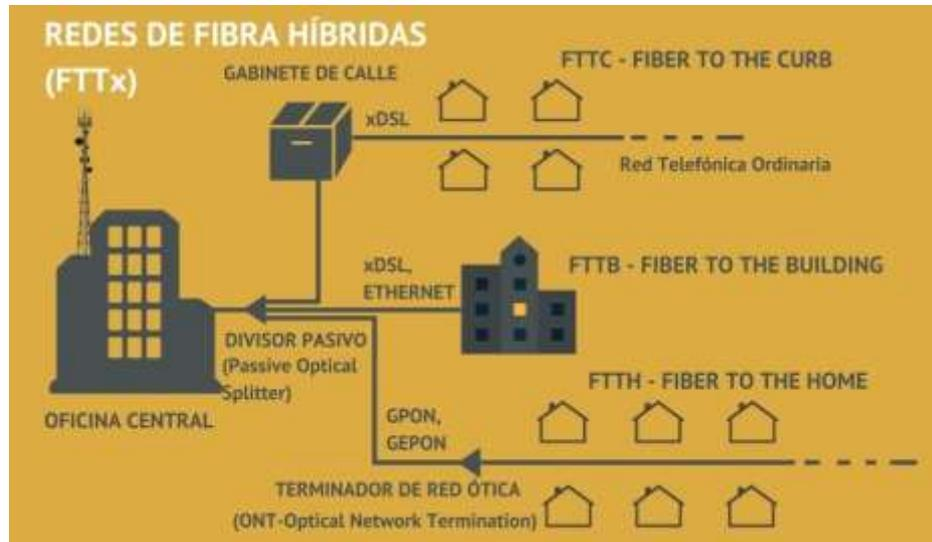
**Ilustración 7-2:** Diagrama de la red híbrida FTTx.
