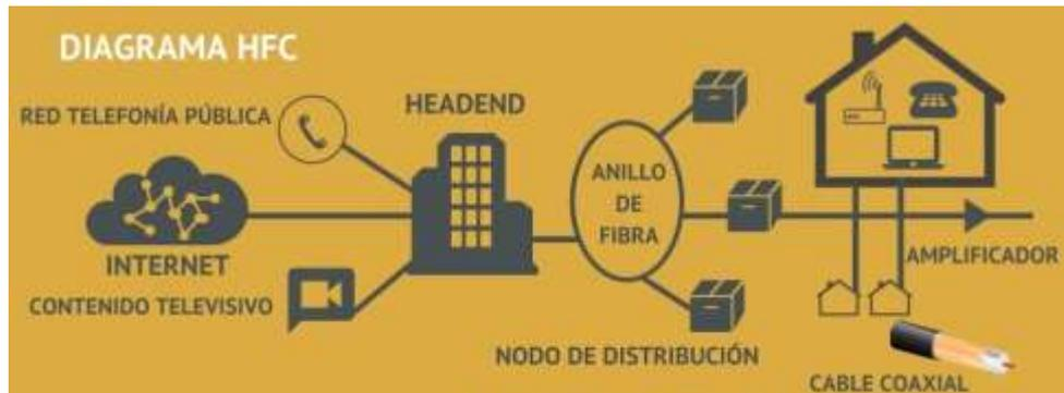
**Ilustración 5-2:** Diagrama de la red híbrida de coaxial y fibra óptica.
