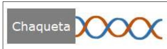
**Ilustración 1-2:** Cable par de cobre con chaqueta
