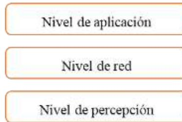
**Ilustración 25-2:** Arquitectura de 3 capas de IoT
