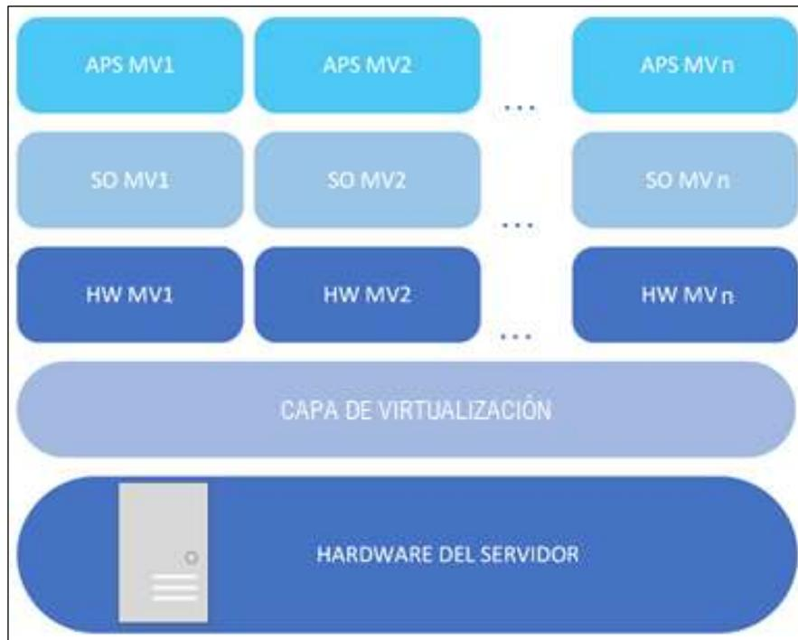
**Ilustración 22-2:** Máquinas virtuales dentro de un equipo físico, con todos los elementos que conformaría un equipo físico
