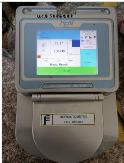
Determinación del índice de refracción
