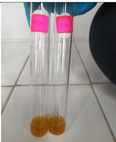
Ensayo de Cloruro ferrico
