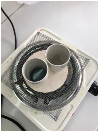
Determinación de % de cenizas solubles en agua
