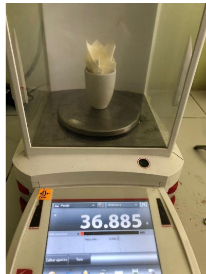
Determinación de % de cenizas insolubles en HCl
