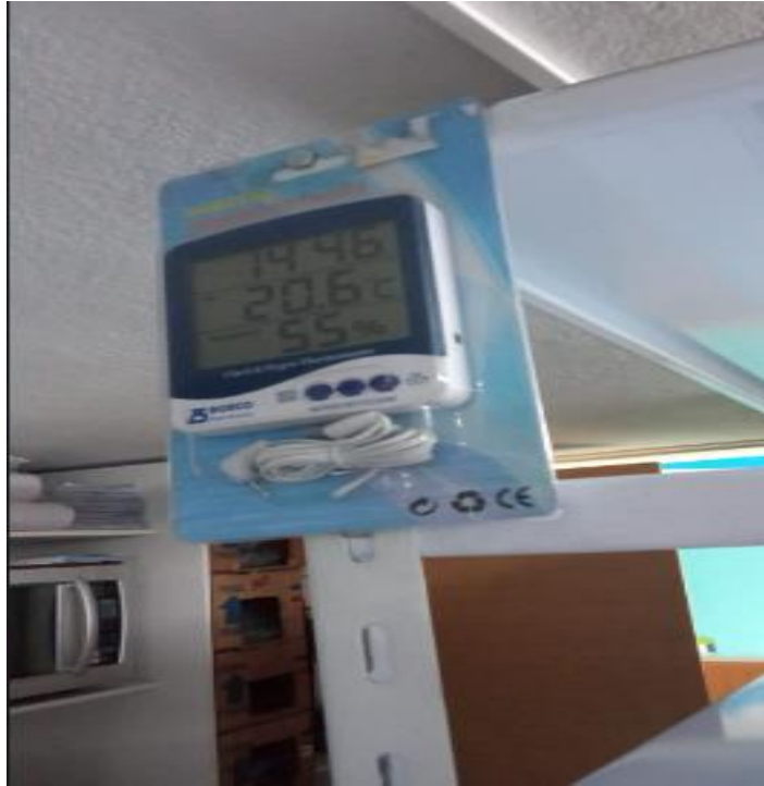
Ilustración 4-20: Termohigrómetro sin calibración
