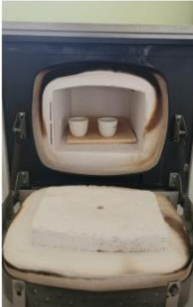
Ensayo de cenizas totales.
