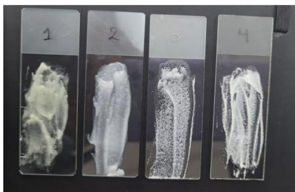
**Ilustración 4-157:** Ensayo de homogeneidad
