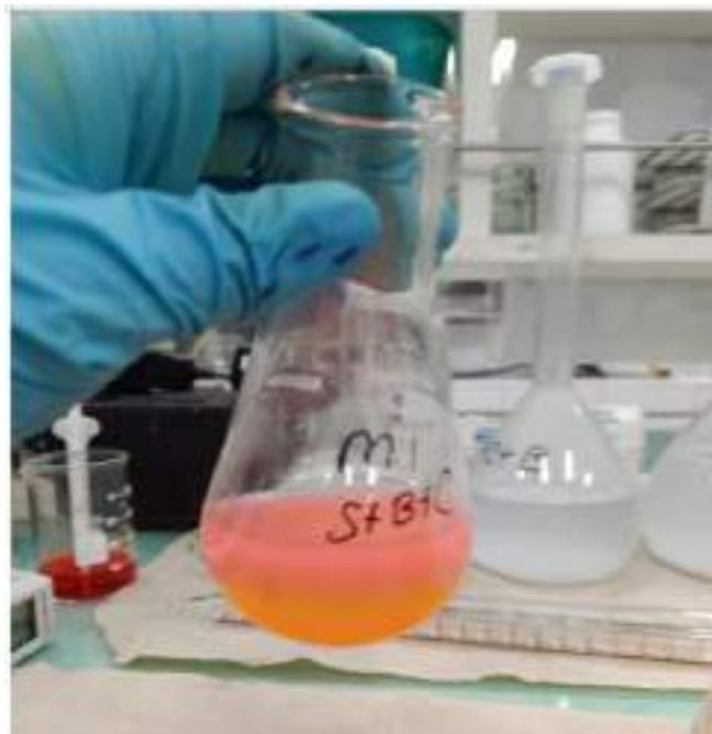
**Fotografía 2.** Muestra valorada con Lauril sulfato de sodio 0,004M hasta que la capa clorofórmica adquiere el primer color rosa anaranjado con un 6,7ml de volumen consumido.
