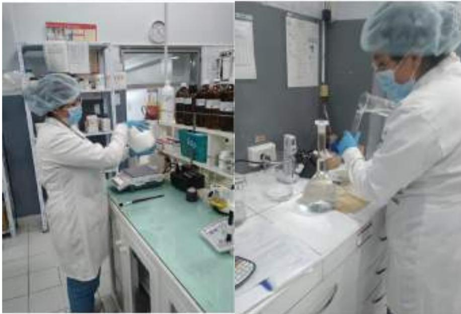
**Fotografía 6.** Preparación de los diluyentes Ácido clorhídrico 0,1N(A) y ACN: H<sub>2</sub>O(B)
