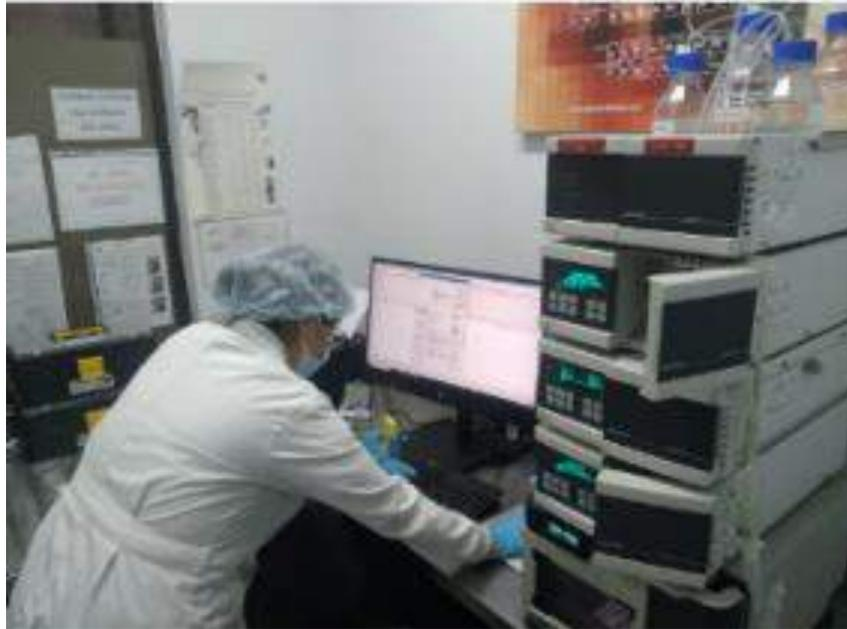
**Fotografía 3.** Equipo HPLC (cromatografía líquida de alta resolución).
