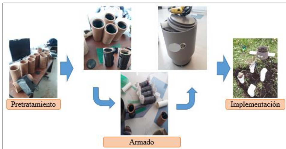
Figura 8-2. Proceso de diseño e implementación de las PMFCs en las estaciones meteorológicas.
