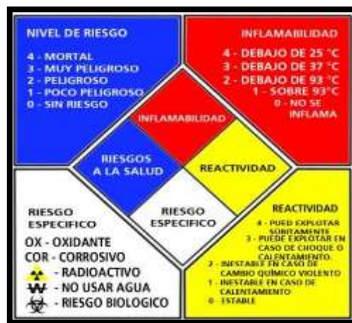
Figura 2-1: Rombo de Seguridad según Código NFPA 704
