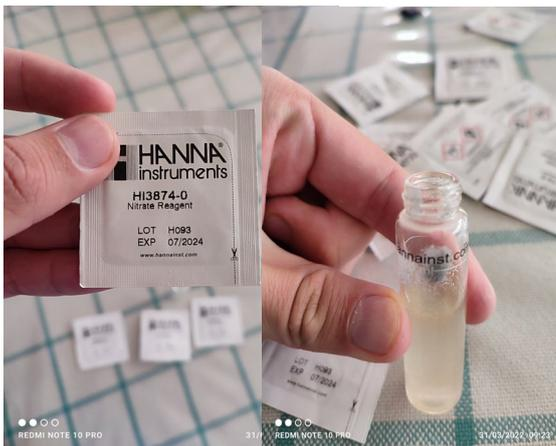
**Fotografía 3E:** Añadimiento del sobre de reactivo el cual se basa en método de reducción de cadmio para medir el nitrato, y agitamos por 1 min.
