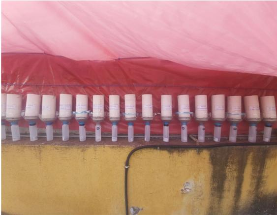
**Fotografía 1C:** Disposición en vertical de las 20 columnas de estudio con el sistema de recolección correspondiente.
