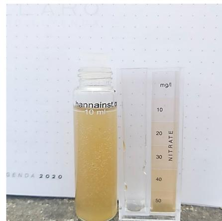
**Fotografía 4C:** Determinación del valor de concentración de nitratos, por colorimetría en el cubo de comparación de colores.
