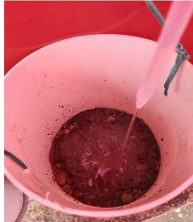
**Fotografía 2C:** Hidratación previa de las columnas de lixiviación.
