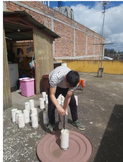
**Fotografía 4C:** Colocación de las muestras de suelo en cada una de las columnas elaboradas.
