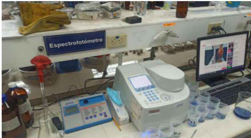
**Figura 11-2.** Análisis del ensayo de fósforo mediante espectrofotometría
