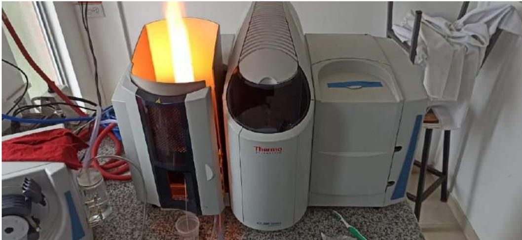
**Figura 14-2.** Análisis de metales pesados por espectrofotometría de absorción atómica
