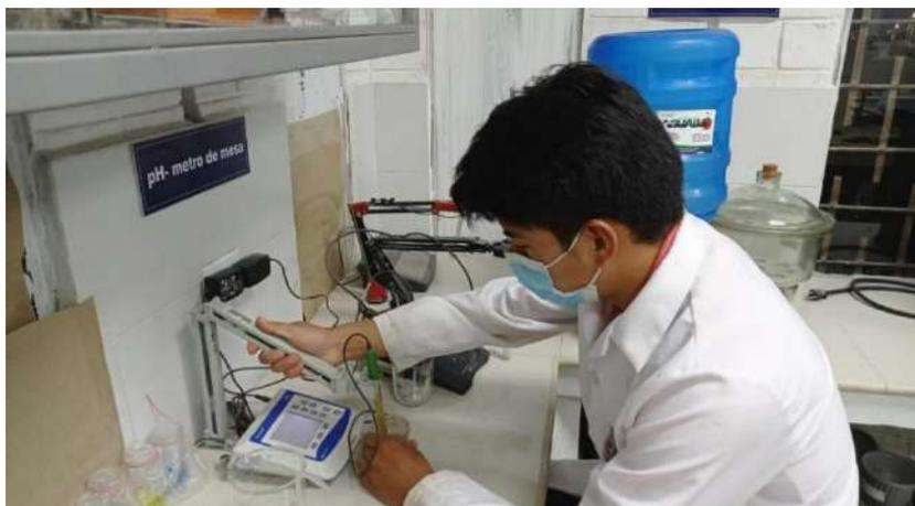
**Figura 7-2.** Análisis del ensayo de pH
