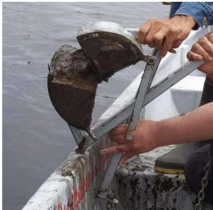
**Figura 3-2.** Equipo draga con forma de tijeras tipo ponar
