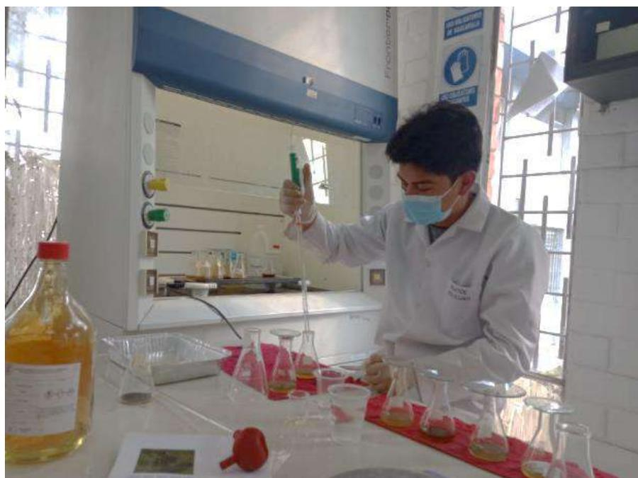
**Figura 13-2.** Extracci3n de metales pesados mediante digesti3n 3cida
