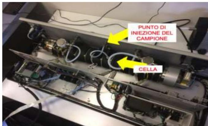
**Figura 2-2.** Espectrómetro láser all'interno.
