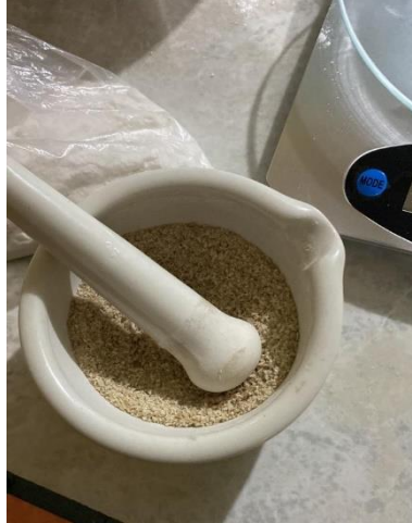
Ilustración 2 : triturado del almidón
