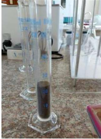
**Figura 19.** Determinación de densidad aparente en suelo.
