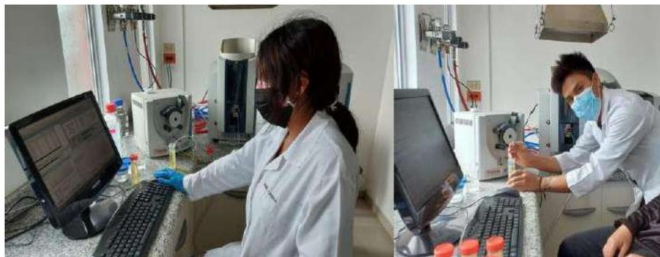
**Figura 43-2.** Medición de mercurio mediante EAA con generador de hidruros
