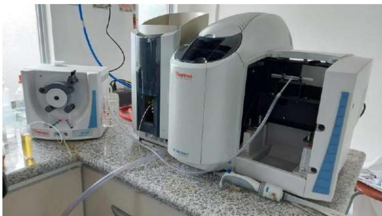
**Figura 42-2.** Calibración del equipo de EAA con generador de hidruros
