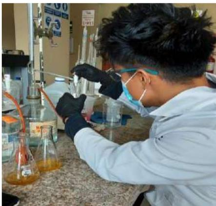
**Figura 38-2.** Medición de cloruros por el método argentométrico
