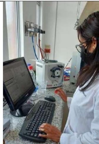
**Figura 30.** Medición de cadmio y plomo en muestras digestadas.
