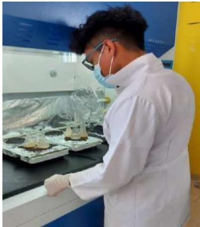
**Figura 27-2.** Digestiones de muestras de biomasa
