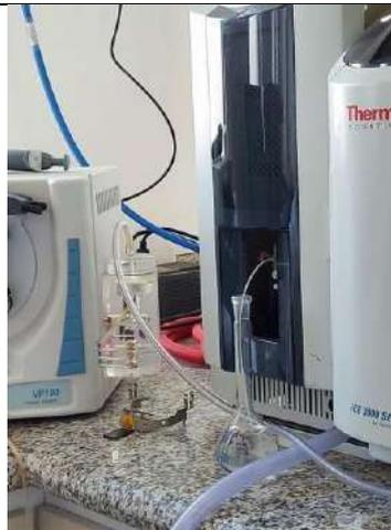
**Figura 29.** Construcción de la curva de calibración para cadmio y plomo
