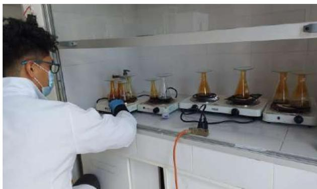
**Figura 21-2.** Digestión de suelos con  $H_2SO_4$
