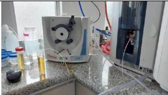
**Figura 53.** Medición de mercurio mediante EAA con generador de hidruros.
