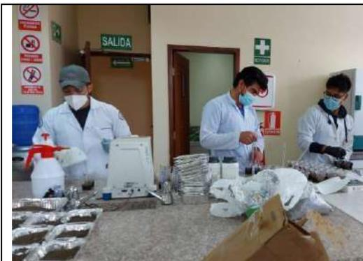
**Figura 17.** Preparación de la solución para medición de pH y CE en muestras de suelo.
