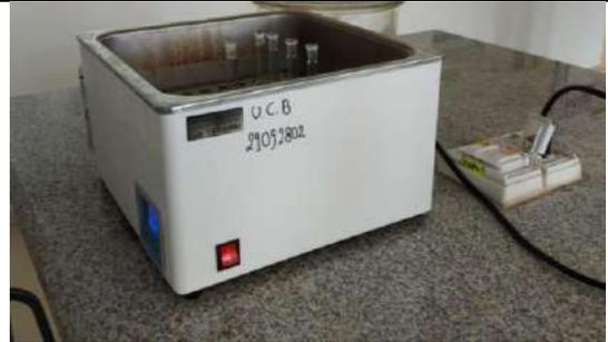
**Figura 56.** Reducción de selenio en estándares mediante calentamiento y adición de HCl.
