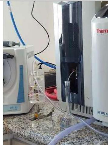
**Figura 50.** Construcción de la curva de calibración para cadmio y plomo
