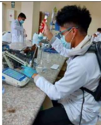
**Figura 23.** Neutralización para determinación de P en suelo.
