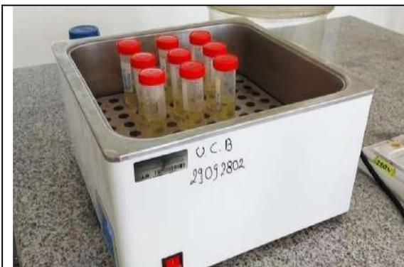
**Figura 57.** Reducción de selenio en muestras mediante calentamiento y adición de HCl.
