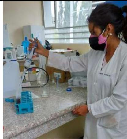
**Figura 64.** Preparación de extractos para determinación de IG
