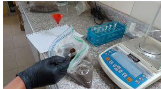
**Figura 18.** Determinación de densidad real en suelo.
