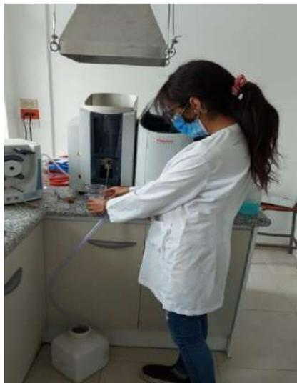
**Figura 23-2.** Determinación de Potasio (K) en suelo
