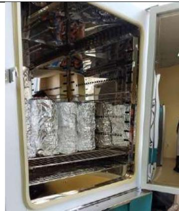
**Figura 66.** Incubación de muestras para determinación de IG
