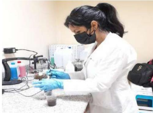
**Figura 33-2.** Medición de pH y CE en compost
