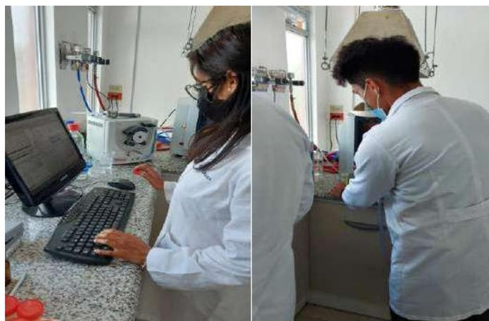
**Figura 41-2.** Medición de cadmio mediante EAA
