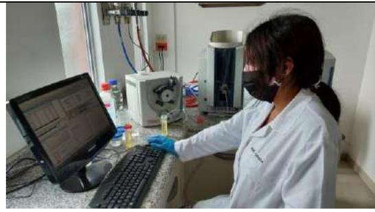
**Figura 54.** Medición de mercurio mediante EAA con generador de hidruros.
