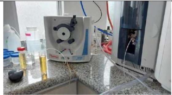
**Figura 34.** Medición de mercurio mediante EAA con generador de hidruros.
