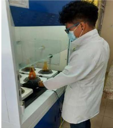
**Figura 25-2.** Digestiones de muestras de suelo
