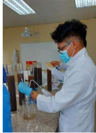
**Figura 20.** Determinación de textura en suelo
