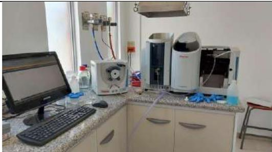
**Figura 49.** Calibración del equipo para medición de cadmio y plomo.
