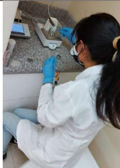
**Figura 22.** Pesado de muestras para la determinación de Carbono y Nitrógeno.
