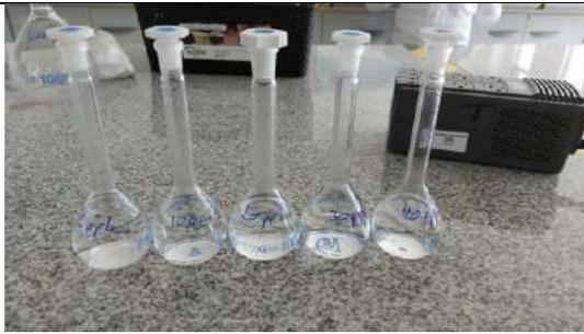
**Figura 33.** Preparación de estándares para la determinación de mercurio.
