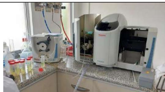
**Figura 58.** Calibración del generador de hidruros y EAA.
