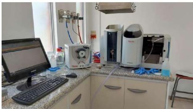
**Figura 39-2.** Determinación de metales pesados mediante EAA
