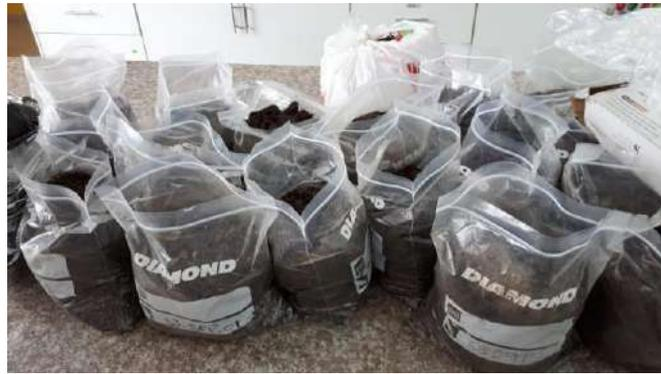
**Figura 7-2.** Secado de muestras de suelo a temperatura ambiente.
