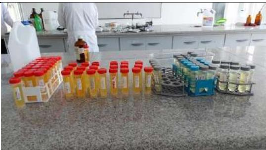
**Figura 27.** Preparación de muestras para determinación de cadmio y plomo.
