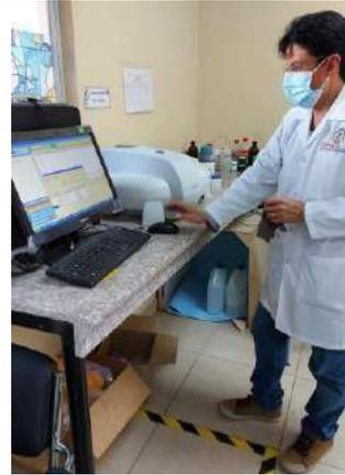
**Figura 46.** Determinación de P en biomasa.
