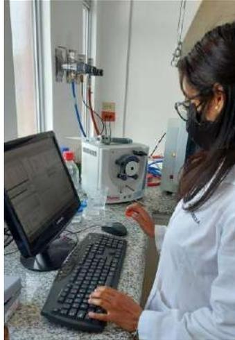
**Figura 51.** Medición de cadmio y plomo en muestras digestadas.
