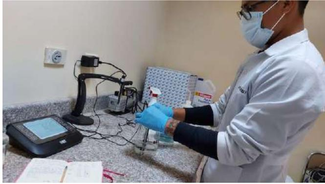
**Figura 13-2.** Preparación de muestras y calibración del pH-metro
