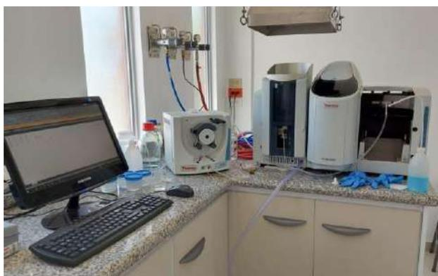
**Figura 29-2.** Determinación de K en EAA para muestras de biomasa
