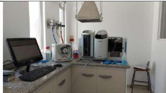
**Figura 48.** Determinación de Na en biomasa.
