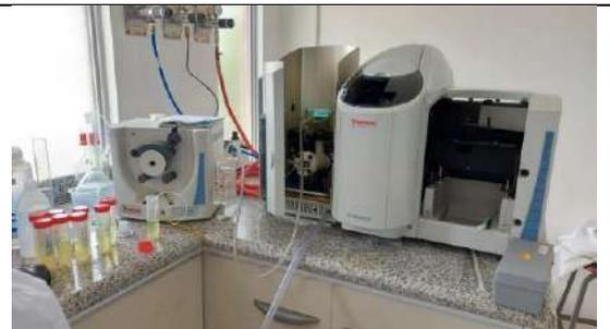
**Figura 38.** liberación del generador de hidruros y EAA.
