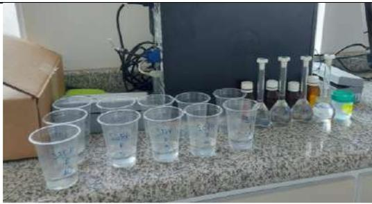
**Figura 47.** Diluciones de biomasa para determinación de Na y K en biomasa.
