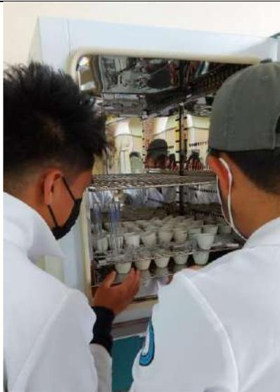
**Figura 21.** Tarado de crisoles para determinar materia orgánica.
