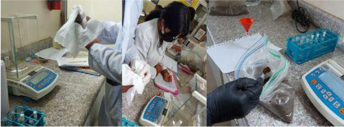
**Figura 19-2.** Determinación de densidad real
