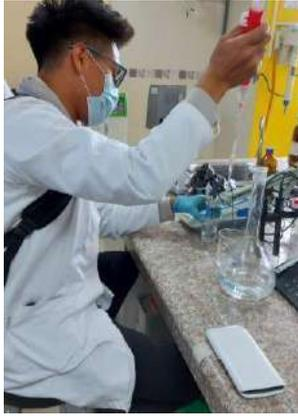
**Figura 45.** Proceso de neutralización para determinación de P en biomasa.
