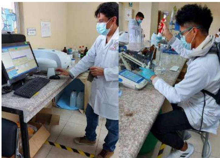
**Figura 30-2.** Determinación de P en EAA para muestras de biomasa
