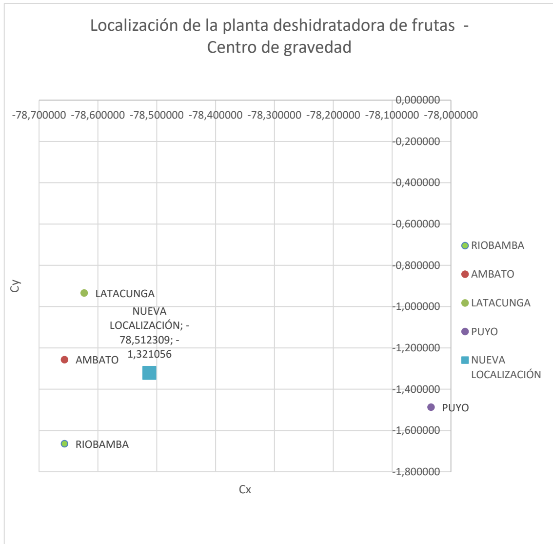
Ilustración 4-1: Localización de la planta deshidratadora aplicando el método del centro de gravedad
