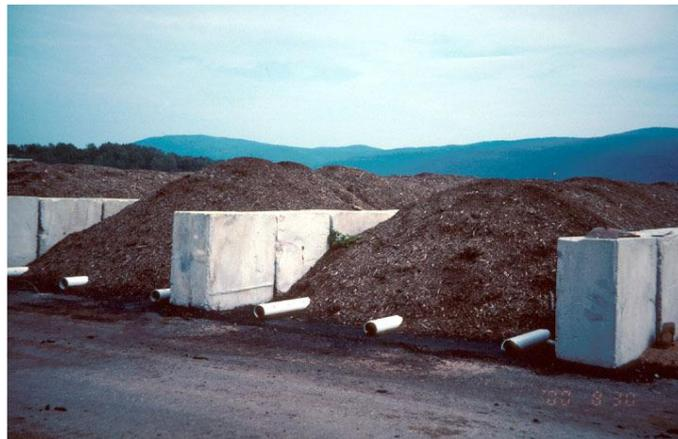
**Figura 3-1:** Pilas estáticas con aireación pasiva
