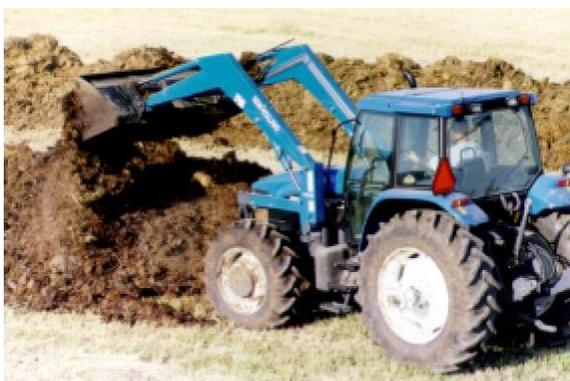
**Figura 5-1:** Pila con volteo mecánico
