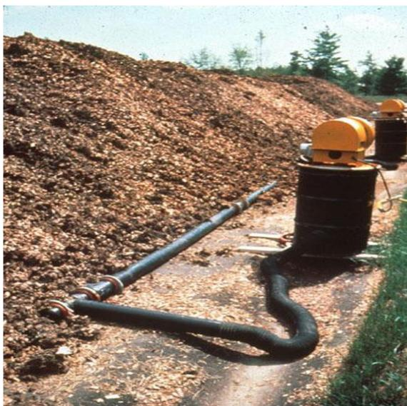
**Figura 4-1:** Pilas estáticas con aireación forzada
