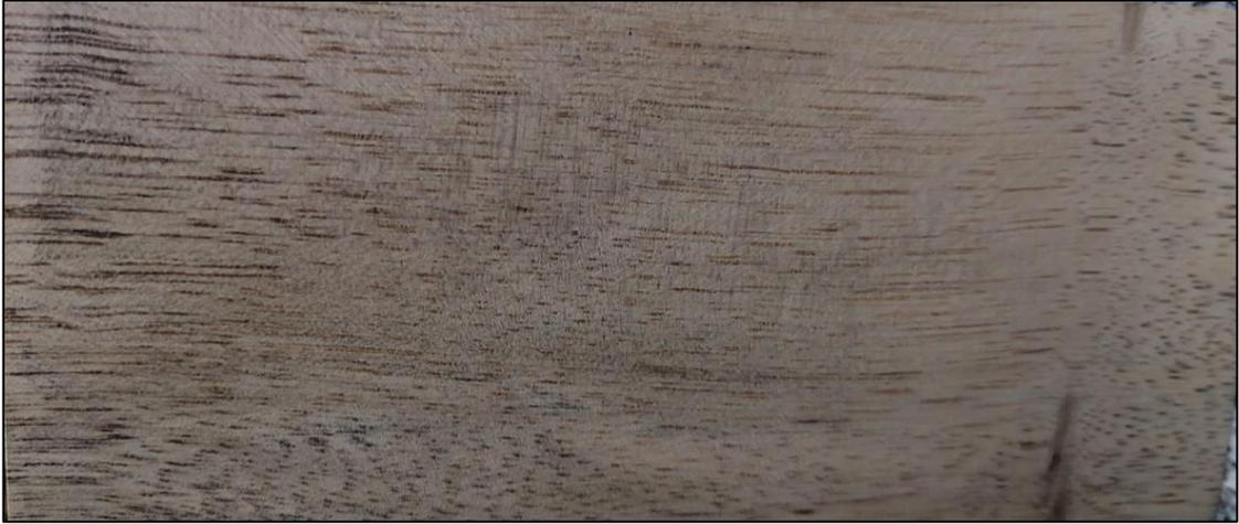
**Ilustración 4-7:** Corte radial en la madera de *Croton tessmannii* Mansf (Tabaquillo)
