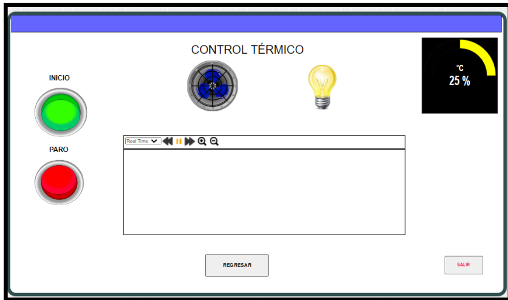
Figura 42- 2: Control térmico de HMI.
