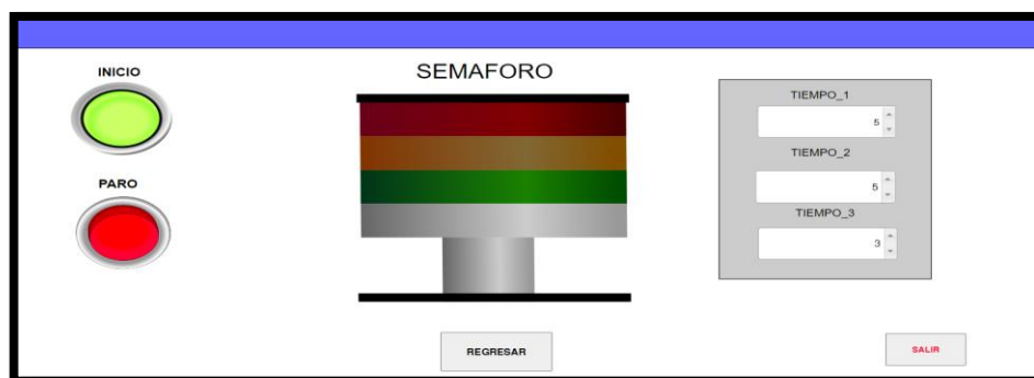
Figura 41- 2: Semáforo de HMI.
