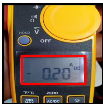
Figura 5- 3: Medición realizada del ventilador.
