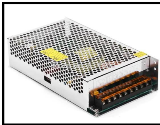
Figura 8- 2: Fuente de 24 V en DC.
