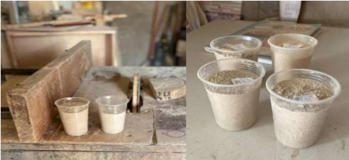
**ANEXO X: PESAJE Y ADICIÓN DE AGUA DESTILADA EN LAS MUESTRAS DE ASERRIN PARA LA TOMA DE CON RESPECTO AL pH**
