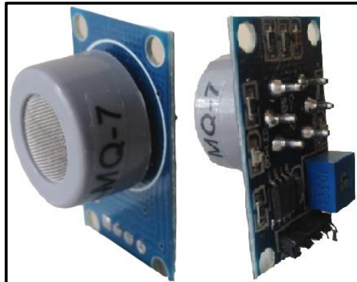
Figura 3-2: Vista anterior y posterior del sensor MQ-7
