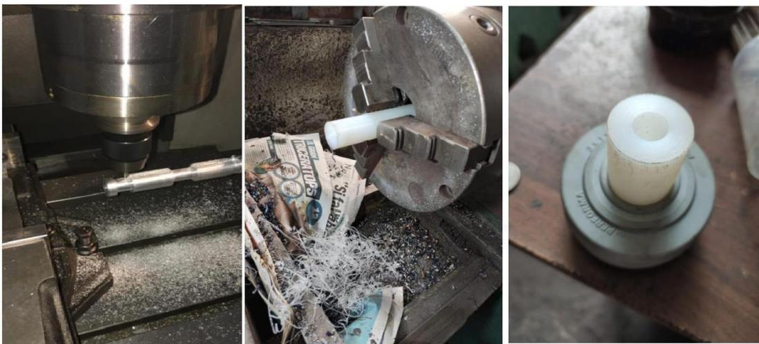
**Figura 9-2:** Corte en torno
