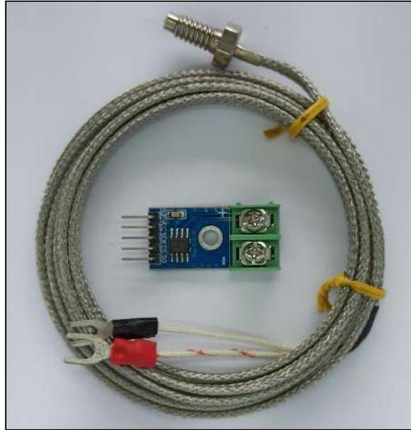
**Figura 7-2:** Sensor de temperatura – termocupla tipo k.
