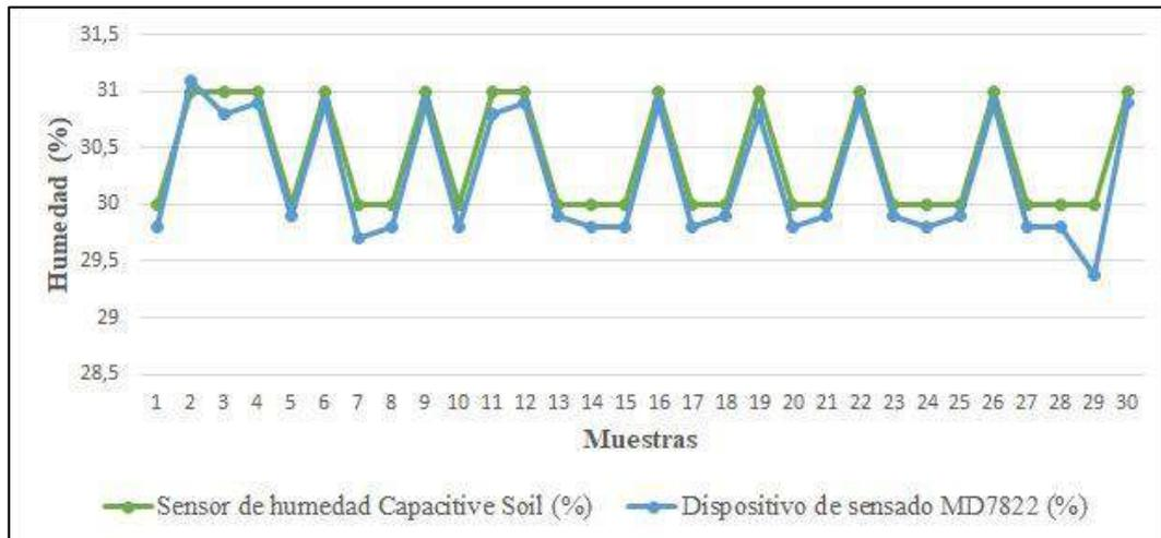
**Gráfica 2-3:** Comparación error en sensores de medición de humedad implementación.
