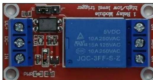
**Figura 11-2:** Módulo relé de 1 canal.
