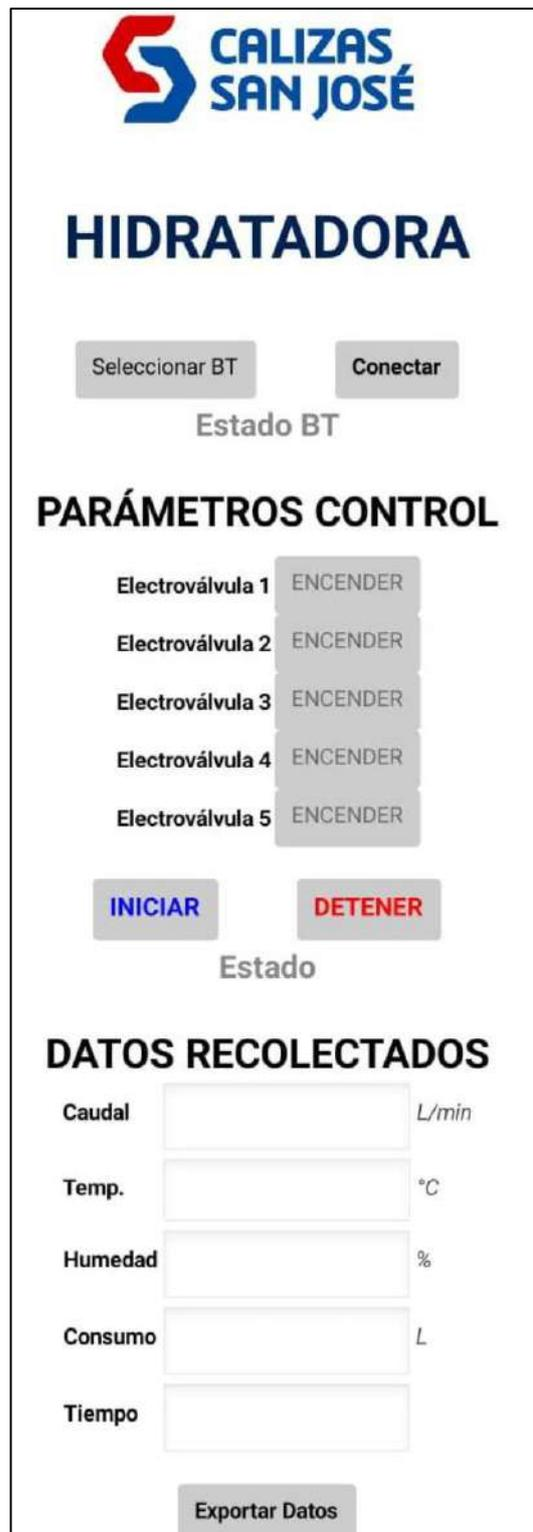
**Figura 16-2:** Visualización aplicación móvil módulo hidratador.
