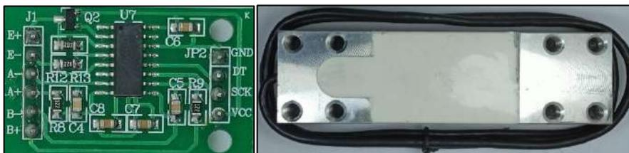
**Figura 13-2:** Celda de carga y módulo hx711.
