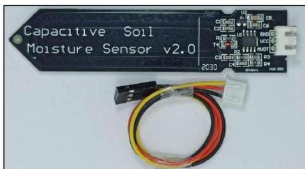
**Figura 8-2:** Sensor de humedad Capacitive Soil.
