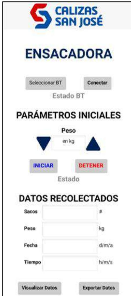
**Figura 17-2:** Visualización aplicación móvil módulo ensacador.
