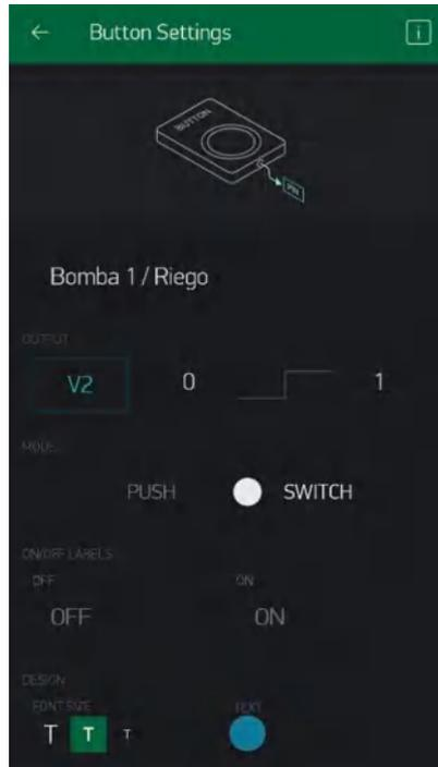
**Figura 25-2:** Configuración de un botón en Blynk
