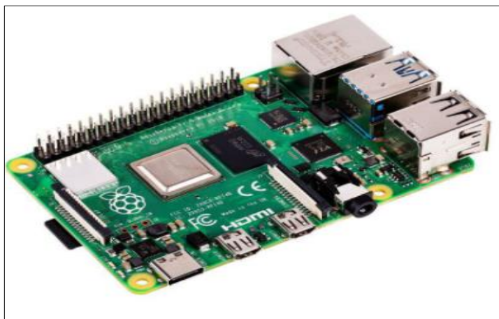
Figura 3-2: Puertos principales de Raspberry Pi 4 model B.
