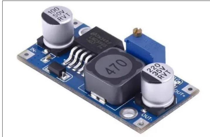
Figura 9-2: Módulo Regulador Step Down Lm2596 3Amp.
