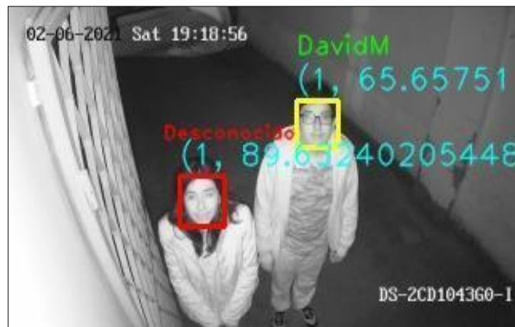
Figura 7-3: Detección e identificación de dos personas.
