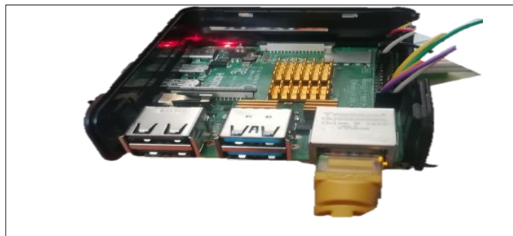
Imagen 1: Conexión mediante cable Ethernet.
