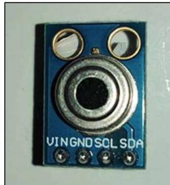
**Figura 4-2:** Módulo GY-906 con sensor infrarrojo MLX90614.
