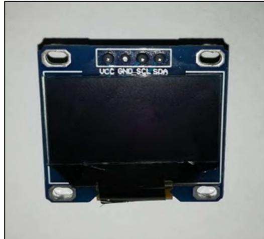
**Figura 5-2:** OLED *display* SSD1306.
