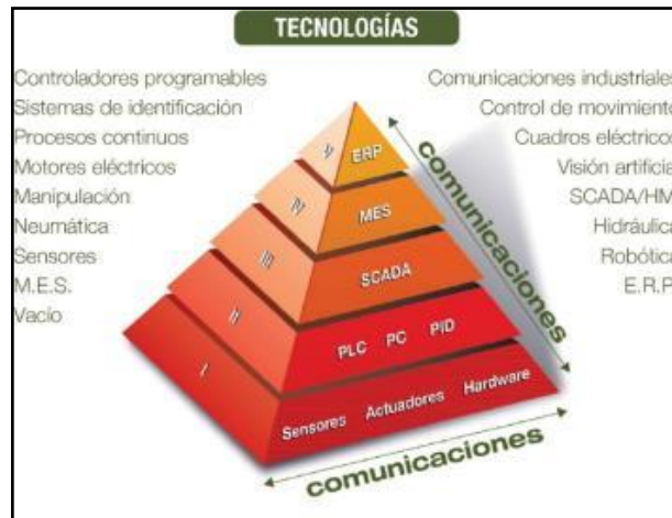
Figura 17-1: Pirámide de la automatización - CIM
