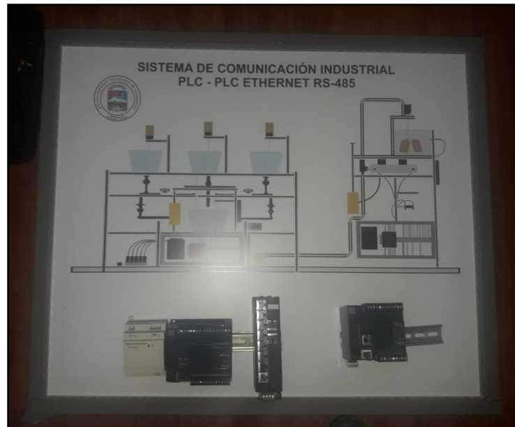
Figura 8-2: Esquema 2 de Comunicación Industrial PLC-PLC
